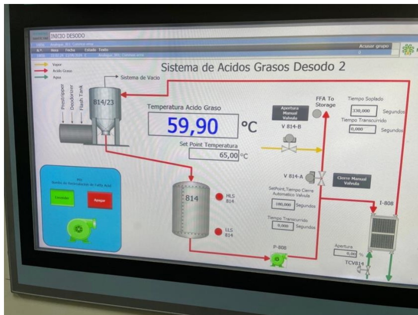
Figura 25: Diagrama de proceso y condiciones de operación para recuperación de la muestra de PFAD
