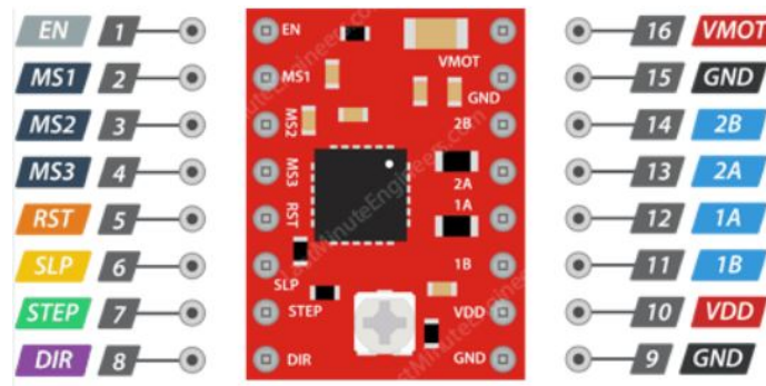
Figura 42: Pinout del módulo controlador del motor - driver A4988.
