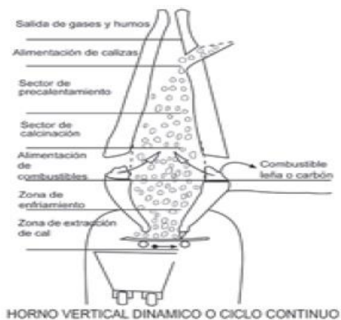
Figura 7. Horno vertical con proceso continuo.
