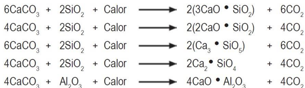
Figura 24. Reacciones químicas de formación de silicatos y aluminatos cálcicos.
