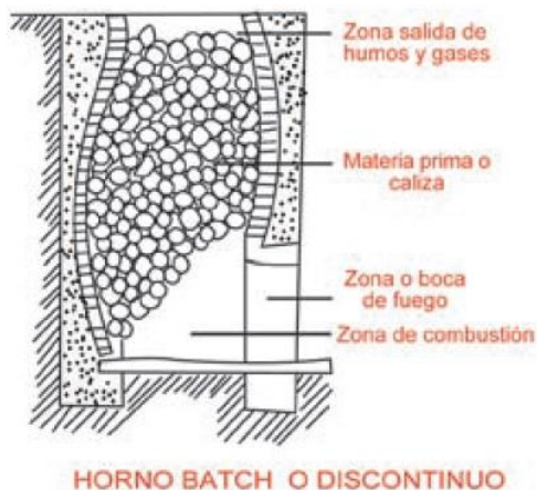
Figura 8. Horno vertical con proceso discontinuo o por batch.
