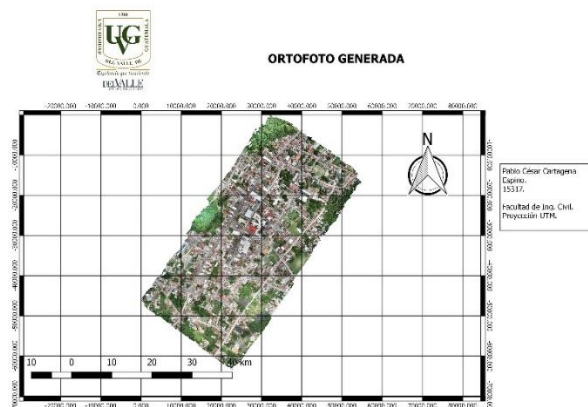
Figura 30: Ortofoto generada en Agisoft PhotoScan y montada en QGIS.
