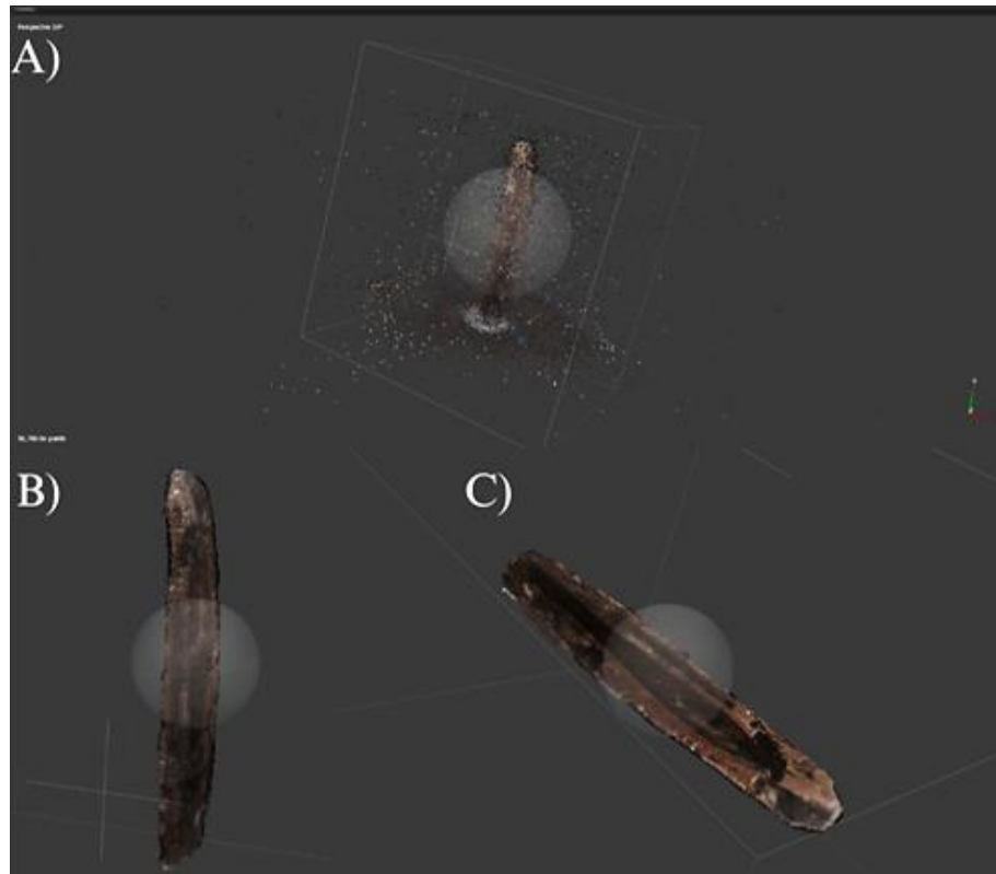
Figura 43. A) Nube de puntos. B) Nube de puntos densa. C) modelo 3D final
