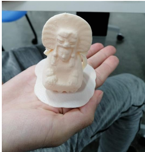
Figura 9. Ejemplo de un silbato creado a partir de fotogrametría impreso en 3D (Fotografía por: Diego López)
