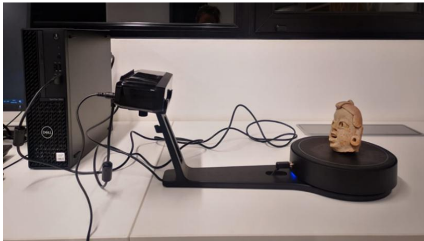
Figura 11. Proceso de escaneo en el escáner EinScan-SP (Fotografía por: Diego López)
