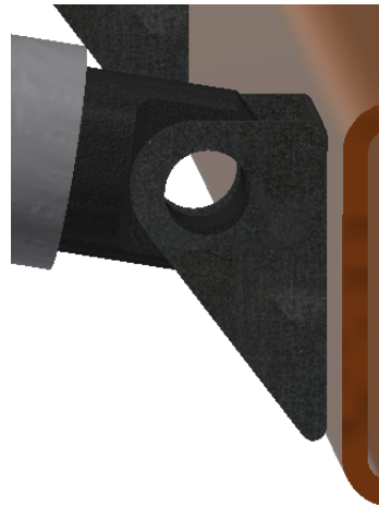
Figura 180: Captura de sección para análisis de soldadura para el acople con pasador.
