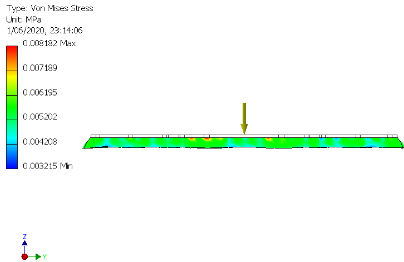
Figura 82: Diagrama de esfuerzos de la placa estabilizadora.
