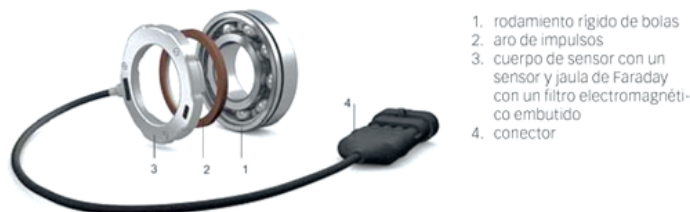
Figura 23: Despiece de rodamiento sensorizado BMD de SKF.
