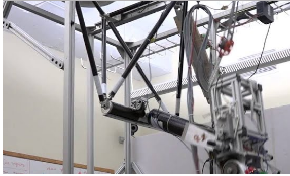
Figura 6: Soporte con tres grados de libertad utilizado para el robot DURUS 2D .
