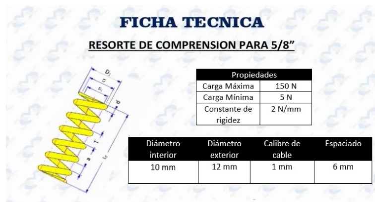
Figura 39: Ficha técnica del resorte del pedal
