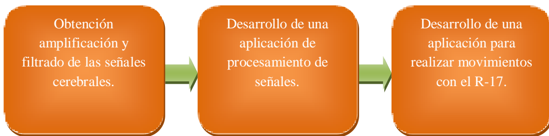
Ilustración 18. Diagrama módulo motriz.
