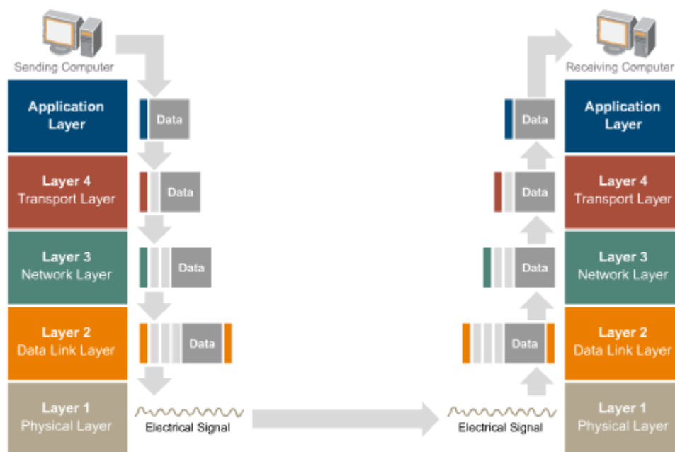
Figura 2. Comunicación entre dos ordenadores a través de una red utilizando el modelo OSI.
