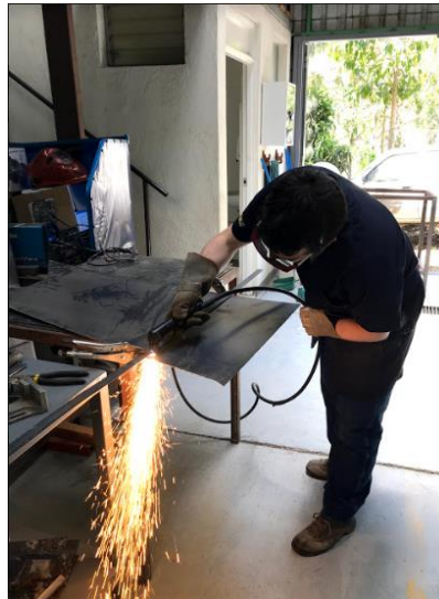
Figura 72. Corte de lámina negra
