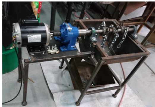
Figura 141 Sistema de transmisión con acoples instalados.
