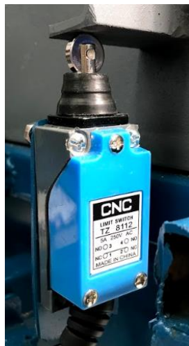
Figura No.6. Interruptor de contacto.
