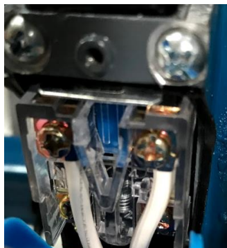
Figura No.7. Interior de interruptor de contacto.
