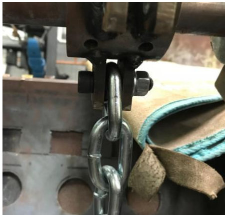
Figura No.6. Uniones de cadenas al eje
