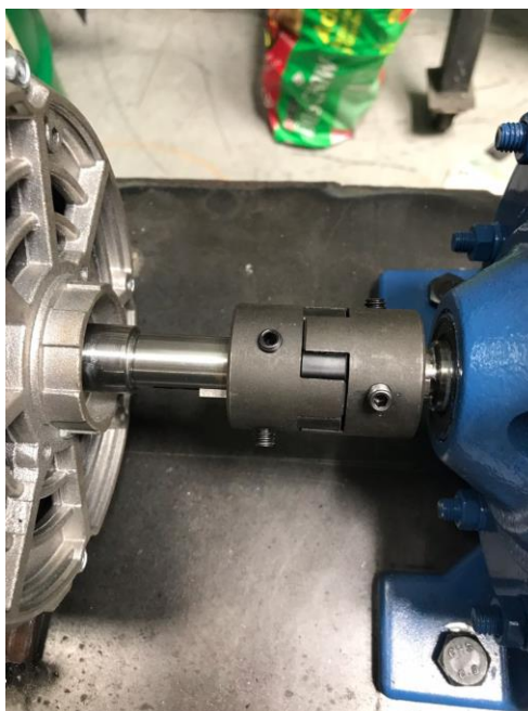
Figura 133 Acople con elastómero de mandíbula que une un reductor y motor-
