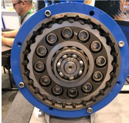
Figura 131 Interior del reductor elegido
