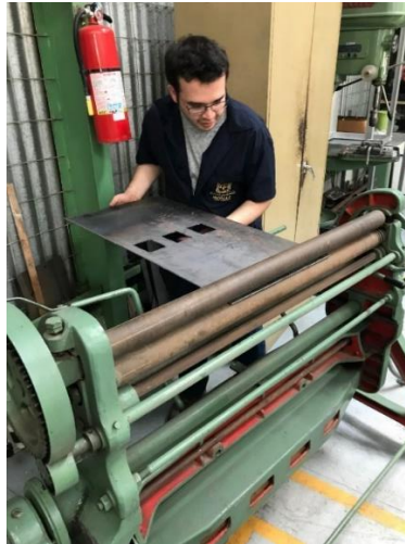
Figura 75. Rolado de lámina de tambor inferior
