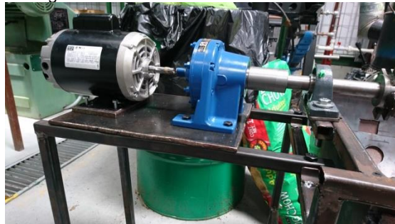
Figura 140 Sistema de transmisión montado.
