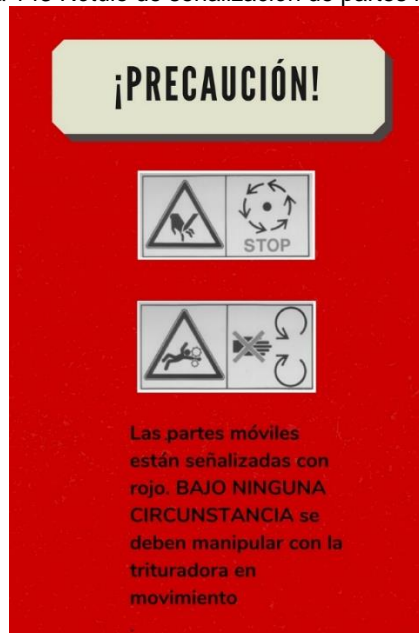
Figura 143 Rótulo de señalización de partes móviles.
