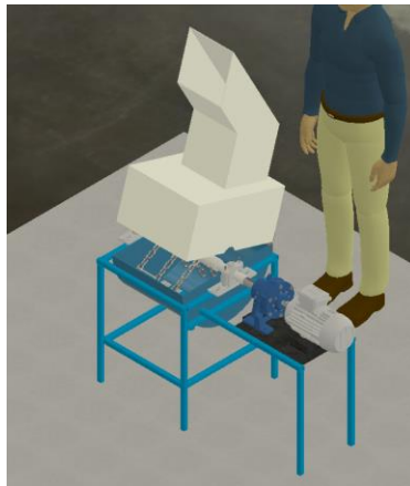
Figura 84 Concepto preliminar con reductor cicloidal
