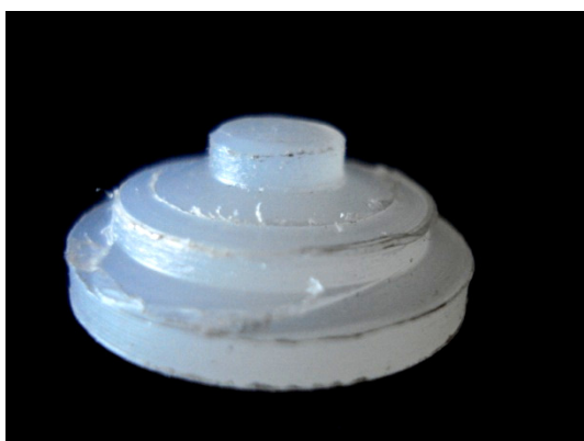
Figura 182. Soporte de masas, vista inferior. El diámetro que se observa en la parte superior de la figura es el que va sobre el área activa del sensor.
