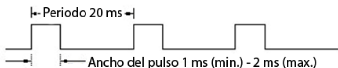
Figura 22. Período y duración máxima y mínima del pulso [19].
