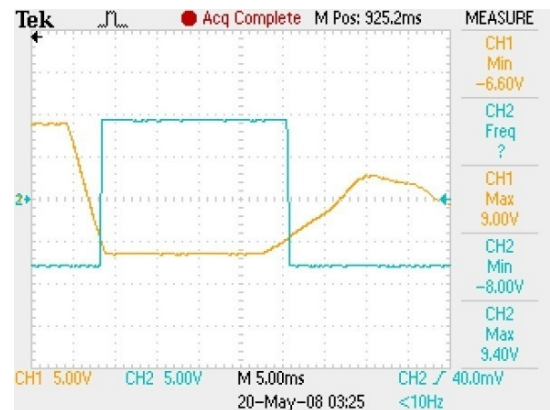
Figura 192. Acercamiento a la salida de la ventana de menor al voltaje de umbral negativo. Salida del sensor (amarillo), salida del comparador (azul).
