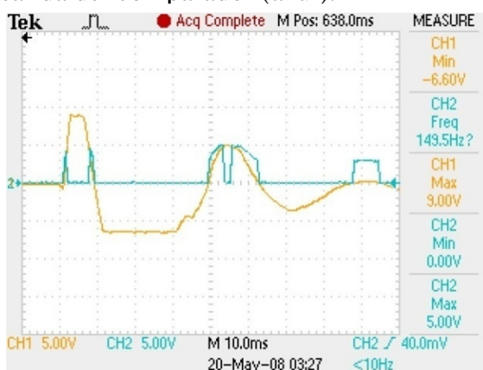
Figura 193. Salida de la ventana para voltajes entre 0 y 5V. La salida del sensor se ve en amarillo, mientras la salida del comparador se encuentra en azul.
