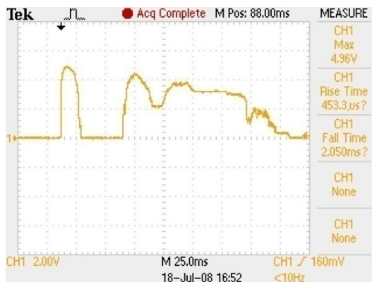
Figura 177. Prueba 4, Impulso con varios rebotes.
