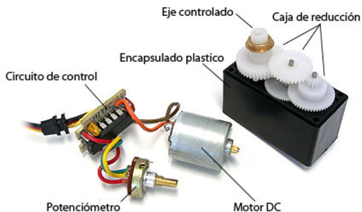
Figura 21. Partes de un servo [18].
