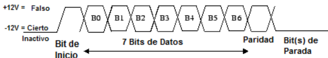
Figura 59. Palabra de transmisión del protocolo RS-232 [61]
