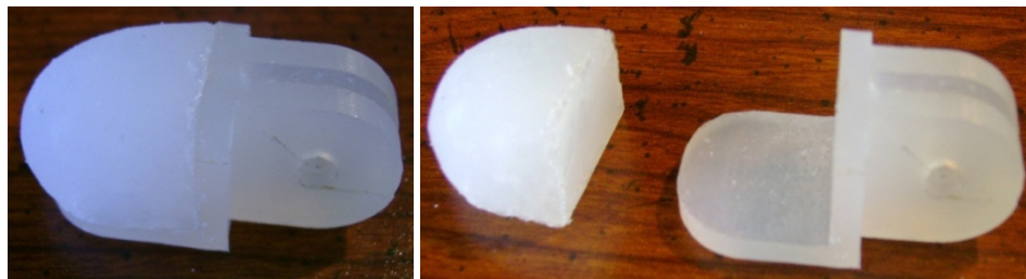
Figura 112. Yema del dedo terminada. Ésta se despega de la falange distal para poder colocar el sensor de fuerza.
