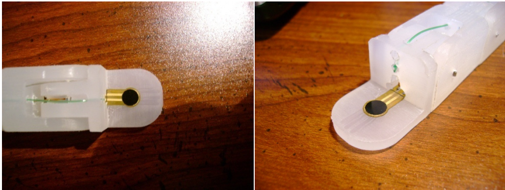
Figura 202. Posición del sensor de fuerza y contacto en la estructura de polipropileno de un dedo.
