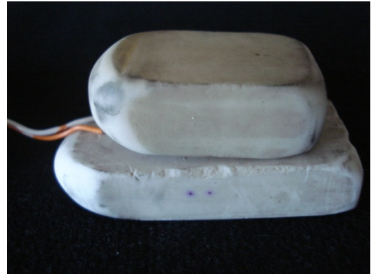
Figura 165. Sensor piezoeléctrico entre dos borradores de hule, para realizar pruebas.
