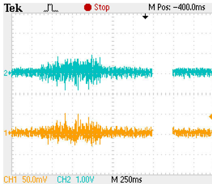
Figura 161. Post-amplificación de la señal EMG. En amarillo, señal de la amplificación diferencial con amplitud de 50mV. En azul, señal de salida de la etapa de amplificación con un transistor con amplitud de 1V.
