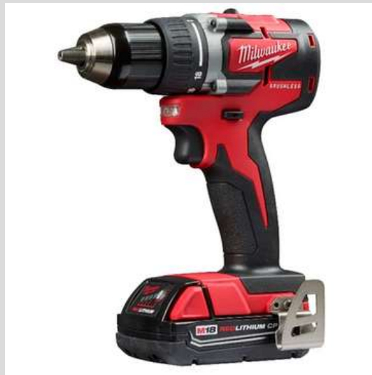
FIGURA 7: HERRAMIENTA PARA PERFORAR AGUJEROS EN LAS PIEZAS DE MADERA O METAL.
