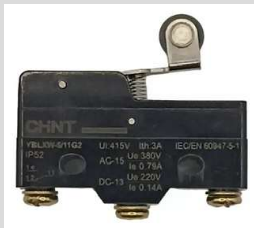
FIGURA 10: INTERRUPTOR PARA CONTROL DE SEGURIDAD EN EL MECANISMO DE LA TRITURADORA.
