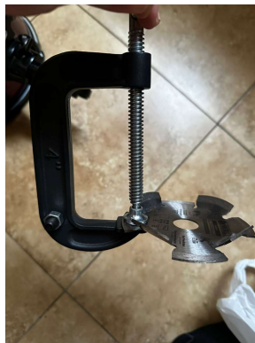
Figura 44: Disco sujetado por prensa tipo C
