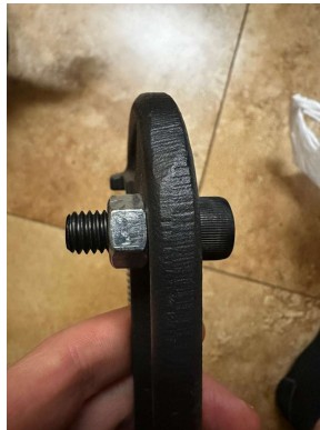
Figura 43: Perno colocado en prensa tipo C
