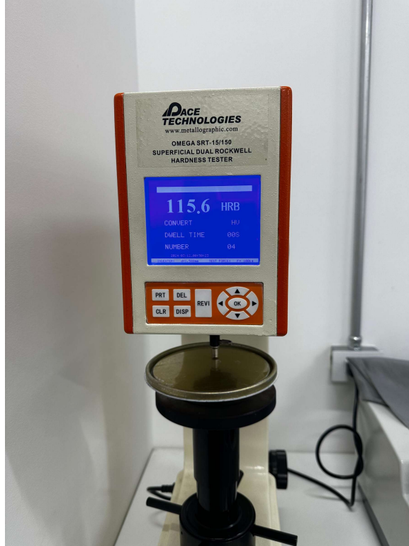
Figura 29: Test de dureza Rockwell tipo B en la cubeta metálica
