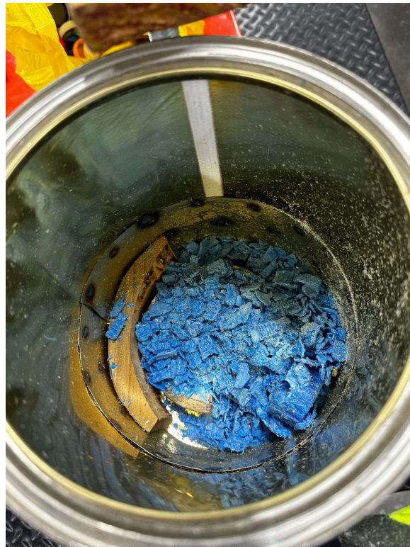
Figura 81: Prueba 5 trituración de hasta 3 x 5 mm y refuerzo en pared
