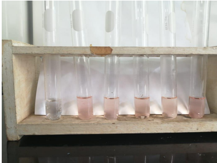
Figura 19. Prueba Shinoda después de verter HCL control negativo, control positivo y extracto 4 al 1 de izquierda a derecha.
