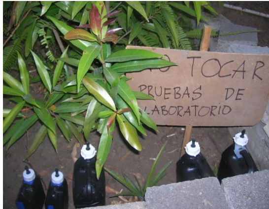
Ilustración 44. Prototipos colocados generando biogás
