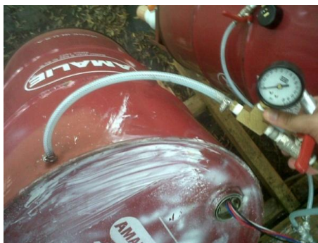
Ilustración 90: Llave de paso acoplada a salida de gas de cámara de digestión
