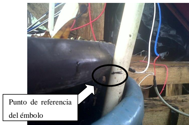
Ilustración 85: Marca de altura inicial de émbolo de cámara de almacenamiento de gas
