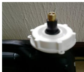
Ilustración 46: Válvula de llanta de automóvil adaptada a tapadera
