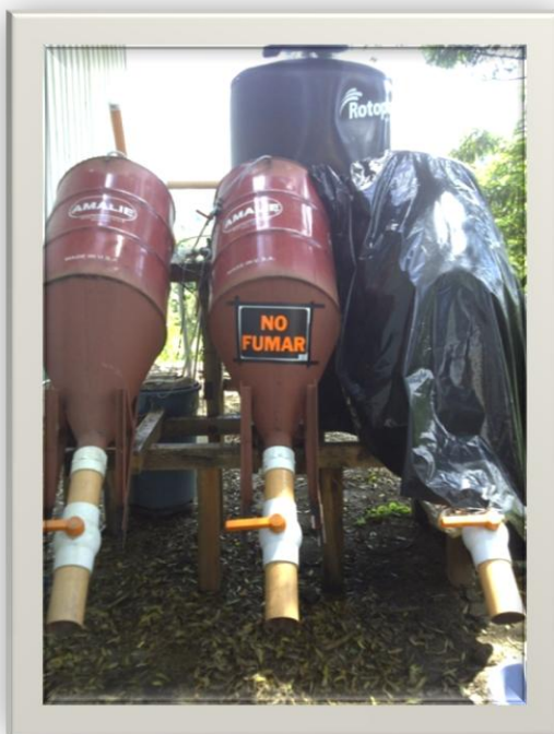
Ilustración 123: Vista frontal del Biodigestor
