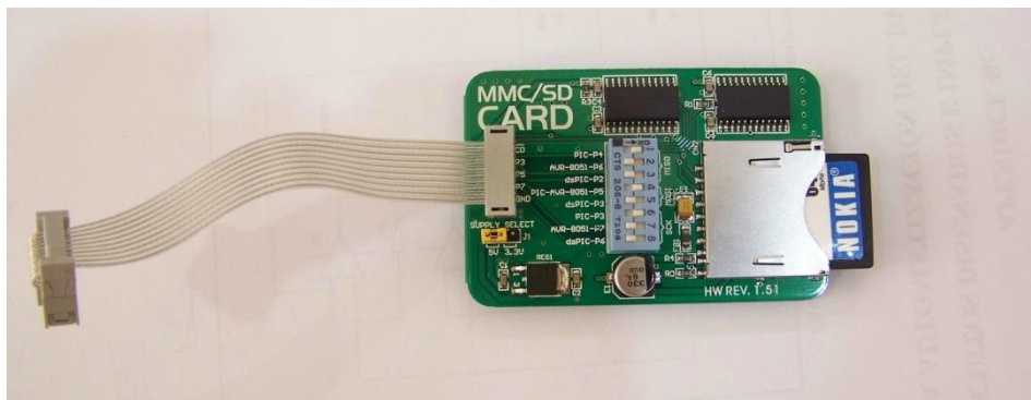
Ilustración 115: Circuito para almacenamiento de mediciones en memoria SD
