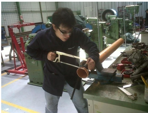
Ilustración 72: Corte de tubería PVC de 4''
