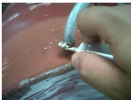
Ilustración 92: Abrazadera de tornillo sin fin adaptada a manguera en salida de gas
