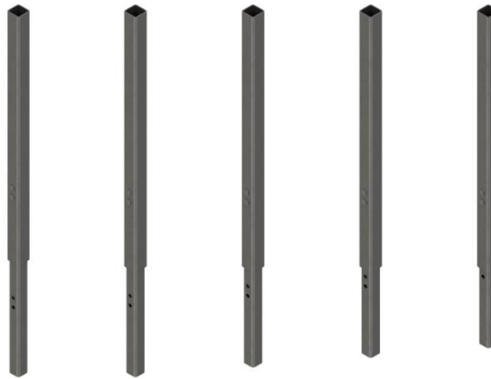
Figura 9. Modelo CAD del sistema telescópico: manga exterior (HSS 1½") y manga interior (HSS 1¼").
