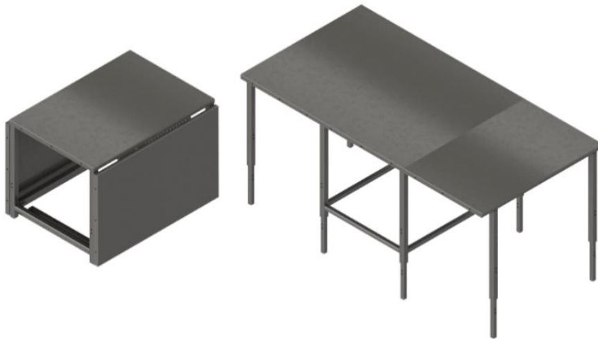
Figura 18. Configuración retraída y desplegada del sistema lateral tipo drop leaf .
