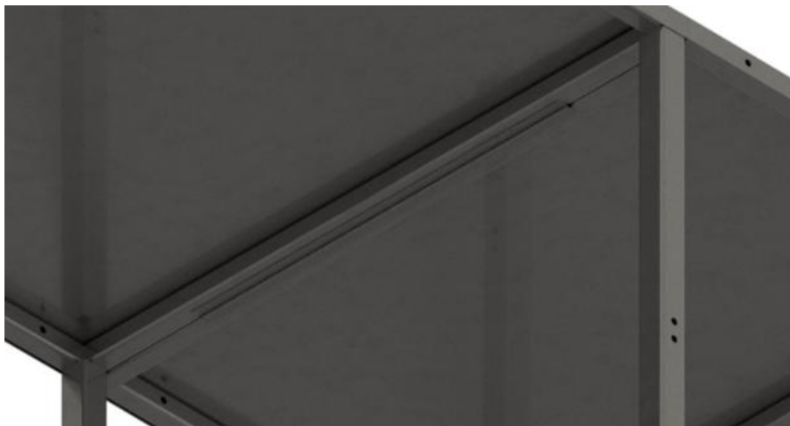
Figura 19. Integración de bisagra continua tipo piano al perfil estructural HSS 1¼".
