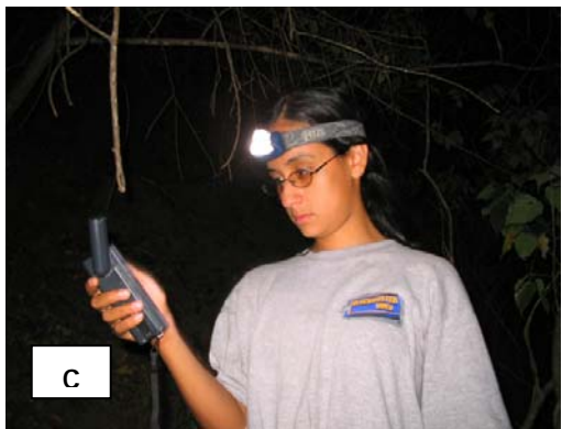
Figura 18. Equipo para la relocalización de los especímenes. Esta figura muestra el equipo de radio telemetría utilizado. Utilicé una antena tipo Yagi de tres elementos y un receptor (caja azul) (fotografía a). El asistente de campo (fotografía b) también se adiestró en el uso de esta técnica. Se tomaron los puntos de GPS de las relocalizaciones (fotografía c).
