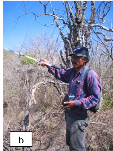
Figura 18. Equipo para la relocalización de los especímenes. Esta figura muestra el equipo de radio telemetría utilizado. Utilicé una antena tipo Yagi de tres elementos y un receptor (caja azul) (fotografía a). El asistente de campo (fotografía b) también se adiestró en el uso de esta técnica. Se tomaron los puntos de GPS de las relocalizaciones (fotografía c).
