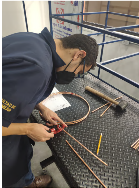
Figura 38: Proceso de cortar tubería de cobre
