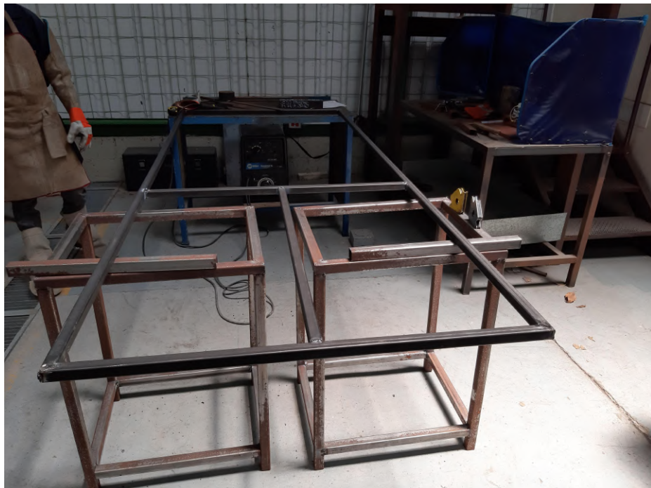
Figura 29: Contorno de un marco para la estructura
