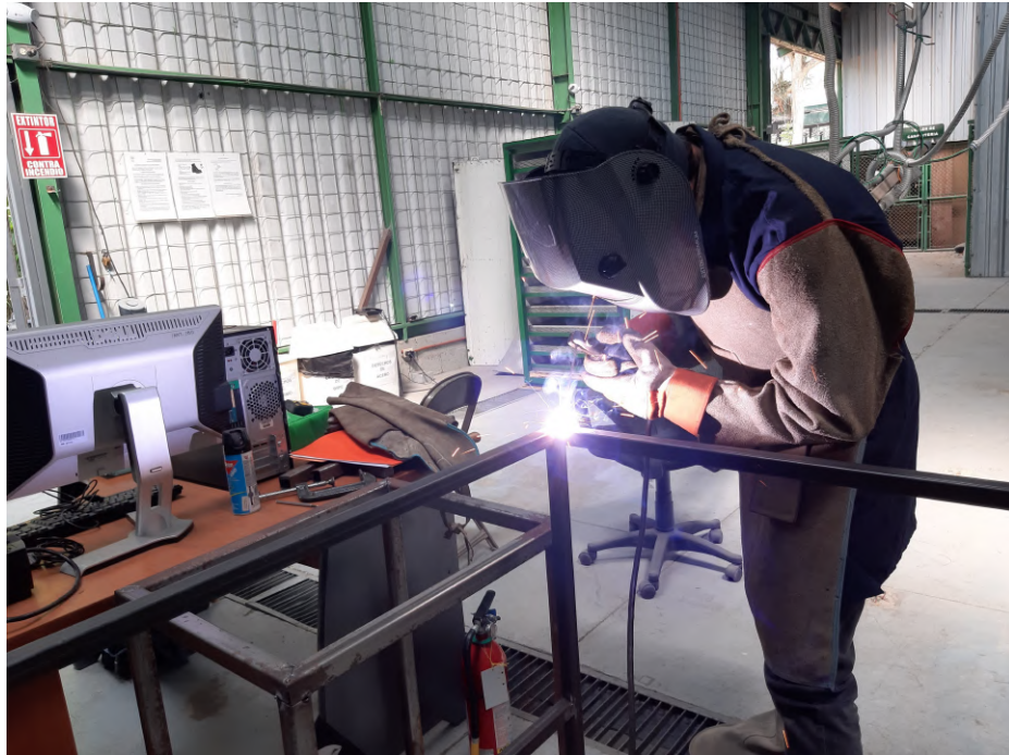
Figura 28: Soldadura de las diferentes uniones de los marcos
