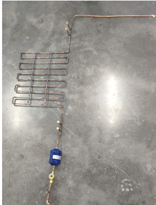
Figura 39: Primera conexión línea de líquido
