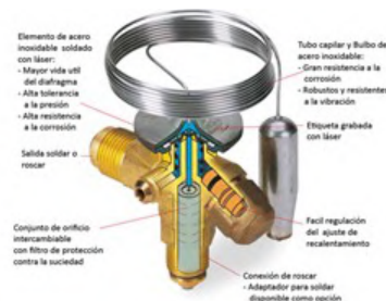
Figura 8: Partes de una válvula de expansión termostática
