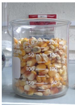
Ilustración 115 - Ejemplo de medición de volumen de maíz, con un beaker de 200ml
