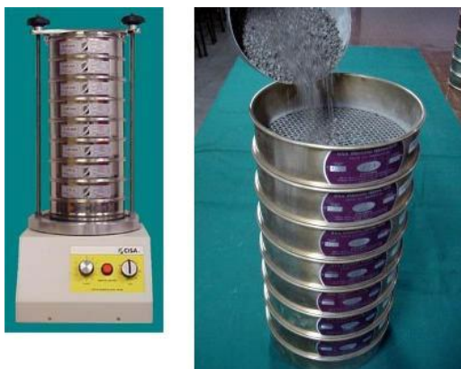
Ilustración 7 - Tamizadora para análisis gravimétrico, a escala laboratorio
