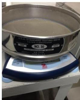
Ilustración 126 - Ejemplo de pesado de un tamiz, Mesh 30
