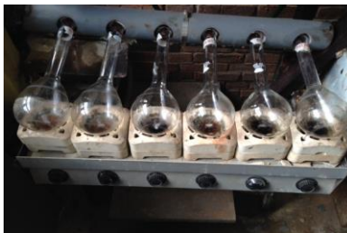
Ilustración 128 - Digestor Kjeldahl durante el análisis de proteínas
