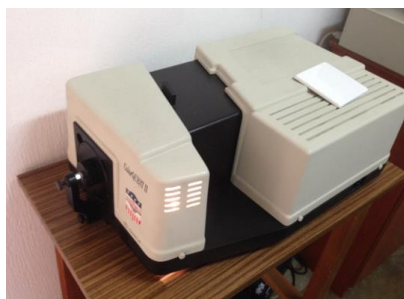
Ilustración 121 - Colorímetro utilizado para medir el color
