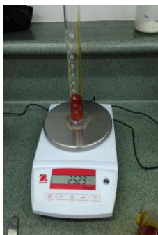
Ilustración 142 - Medición de densidad para el aceite de palma
