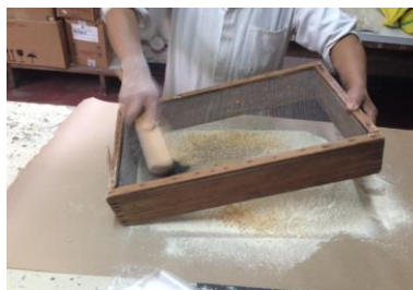
Ilustración 134 - Tamizado del concentrado para uniformidad de partículas
