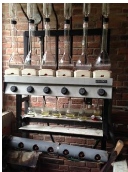
Ilustración 129 - Destilador Kjeldahl durante el análisis de proteínas
