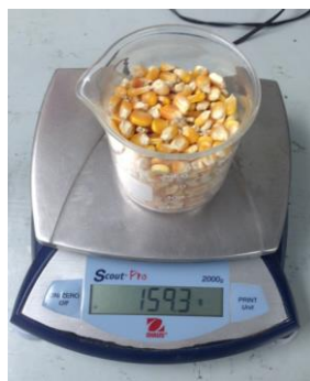
Ilustración 120 - Ejemplo de la medición de la masa del maíz
