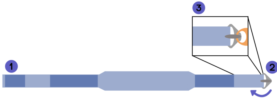
Figura 6. Proyección final del sistema propuesto, conformado por la faja de sujeción, los ganchos y como sujetan la bolsa de ostomía para adultos
