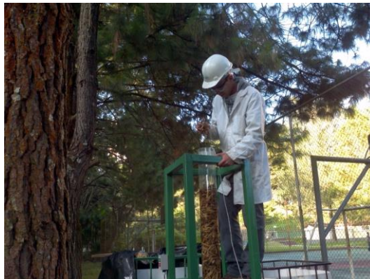
Imagen 20: Llenado de biofiltro con material filtrante (ficus)
