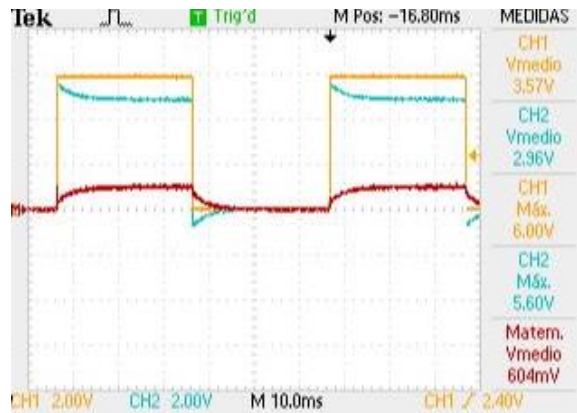
Figura 97: Prueba de estimulación con circuito equivalente para 5 cm de largo con reducción en la resistencia de la membrana celular donde se tiene la entrada (amarillo), la salida luego de 5 cm (azul) y la diferencia entre ambos voltajes (entrada - salida, rojo).
