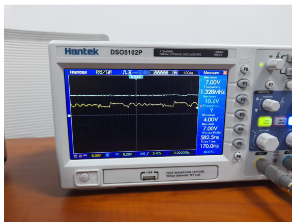
Figura 67: Salida del LM2622 en la placa V1 siendo alimentado con 7 V.
