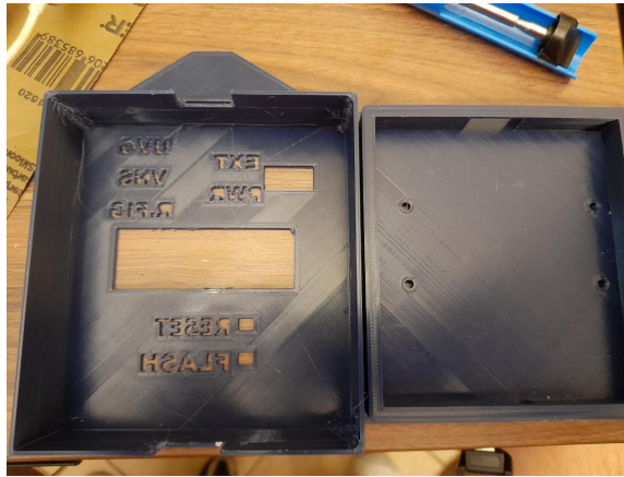
Figura 42: Las dos mitades de la carcasa de la varilla programadora impresas en PLA+ Azul.
