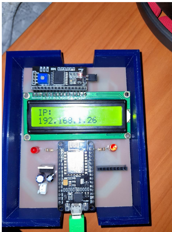
Figura 75: Versión final de la placa para la varilla programadora en funcionamiento.
