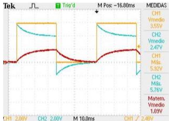
Figura 98: Prueba de estimulación con circuito equivalente para 5 cm de largo con reducción en la resistencia longitudinal donde se tiene la entrada (amarillo), la salida luego de 5 cm (azul) y la diferencia entre ambos voltajes (entrada - salida, rojo).
