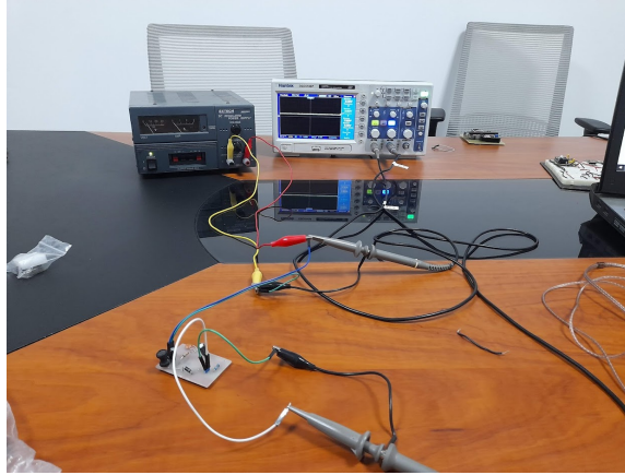
Figura 65: Equipo utilizado para pruebas con la V1 de la placa para pruebas del LM2622.
