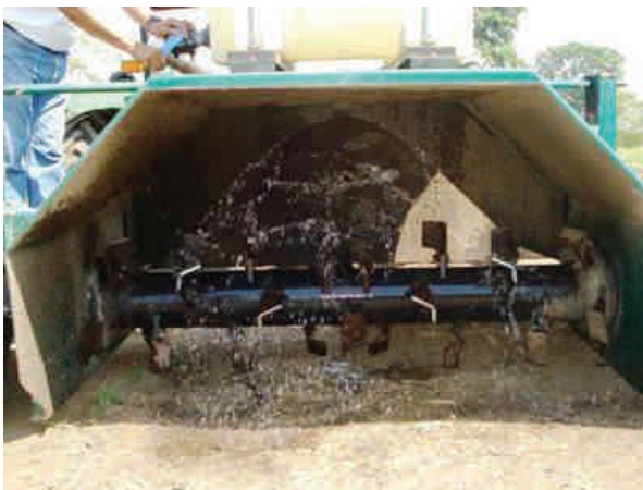
Figura 3. Máquina volteadora del material en la cama. Obsérvese la adición de agua del tanque colocado sobre la estructura que cubre el eje rotatorio mezclador.
