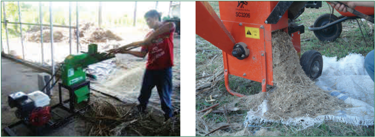
Figura 2. Panorámica del tipo de picadora, izquierda y astilladora, derecha, empleadas para procesar los desechos de caña.
