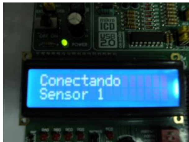
Figura 28: Mensaje mostrado al iniciar la conexión utilizando la instrucción SPP_ESTABLISH_LINK.
