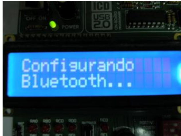
Figura 27 Mensaje mostrado cuando el maestro espera la conexión del teléfono celular.
