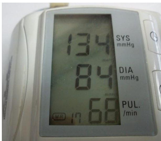
Figura 60: Medición de exactitud en medición de presión sistólica del esfigmomanómetro invadido.
