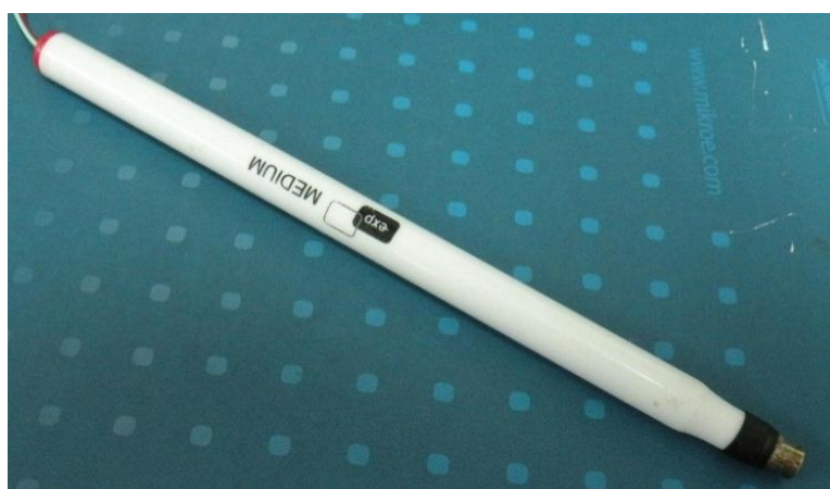
Figura 73: Termómetro oral implementado.
