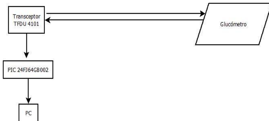
Figura 69: Topología de circuito implementado para la comunicación infrarroja con glucómetro.
