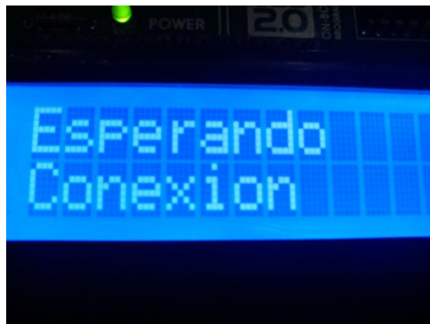
Figura 28: Mensaje mostrado al iniciar la conexión utilizando la instrucción SPP_ESTABLISH_LINK.
