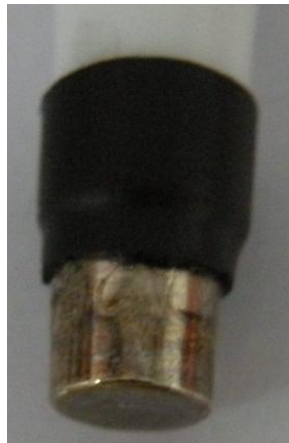
Figura 72: Recubrimiento de termómetro digital DS18B20 en termómetro oral implementado.
