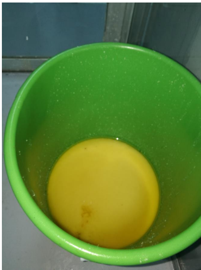
Figura 8. Aceite crudo de palma con muchos sólidos suspendidos
