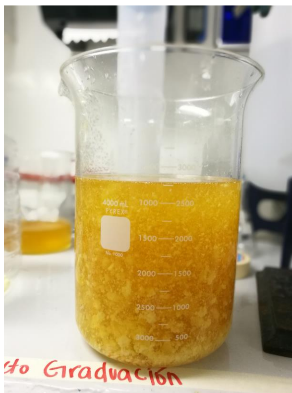
Figura 7. Aceite crudo de palma con pocos sólidos suspendidos.
