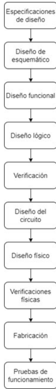
Figura 1: Flujo de diseño VLSI para un circuito integrado
