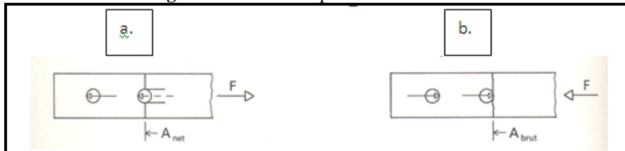
Figura 58 Modo de ruptura cerca de la unión
