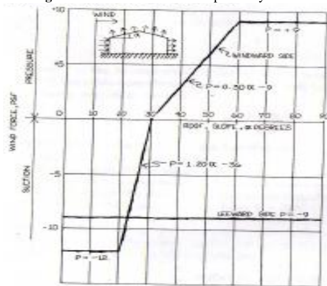
Figura 148 Presión de viento en paredes y techos
