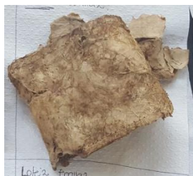
Ilustración 188. Degradación de la toalla sanitaria en un periodo de 80 días de ser enterrada, muestra 2 del primer lote.
