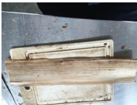
Ilustración 23. Cortex del pinzote de banano después de pasar por el molino de rodillos
