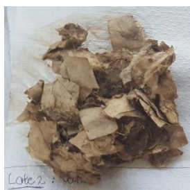
Ilustración 187. Degradación de la toalla sanitaria en un periodo de 80 días de ser enterrada, muestra 1 del primer lote.
