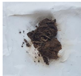
Ilustración 189. Degradación de la toalla sanitaria en un periodo de 80 días de ser enterrada, muestra 3 del primer lote.
