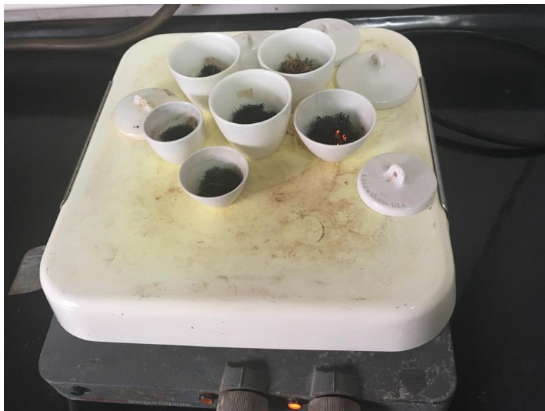
Ilustración 95. Quemado de muestras previo a mufla para prueba de ceniza
