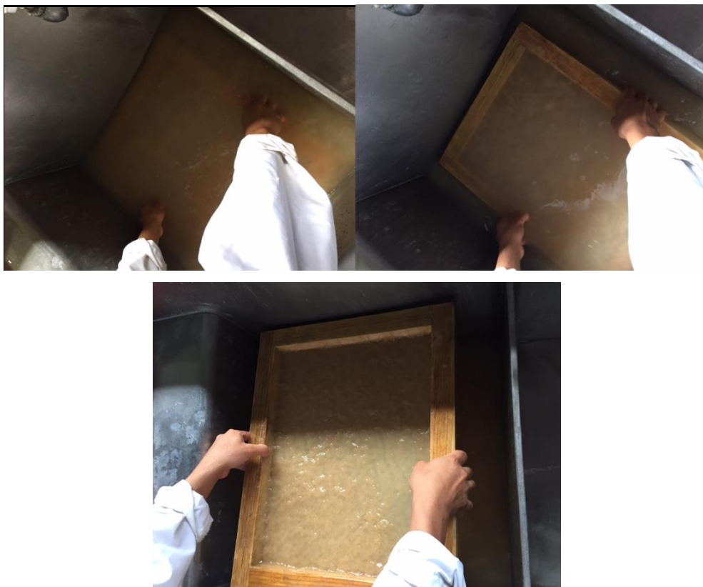
Ilustración 29. Procedimiento para la obtención de pliegos de bobina a base de pasta celulósica
