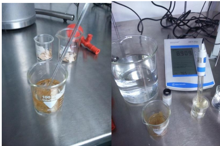
Ilustración 184. Medición de pH de las toallas sanitarias a partir de pliegos de fibra extraída del pinzote de banano.
