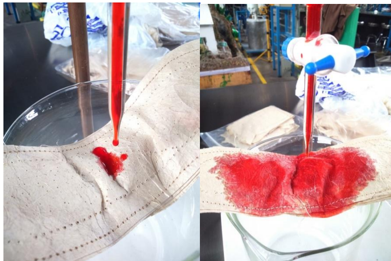
Ilustración 180. Prueba de capacidad de absorción de la toalla sanitaria, utilizando la solución Meds.
