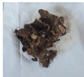
Ilustración 188. Degradación de la toalla sanitaria en un periodo de 80 días de ser enterrada, muestra 2 del primer lote.
