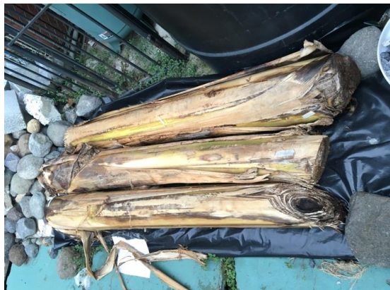
Ilustración 118. Degradación de pseudotallos expuestos al Sol día 11
