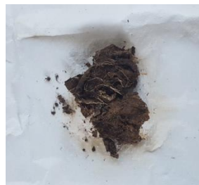
Ilustración 189. Degradación de la toalla sanitaria en un periodo de 80 días de ser enterrada, muestra 3 del primer lote.
