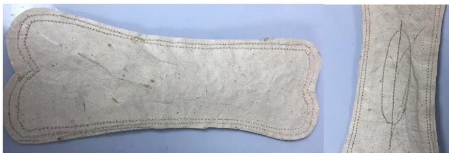
Ilustración 174. Segundo prototipo con alas, costura simple con máquina plana, con perforaciones en la capa superior.
