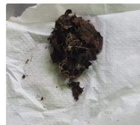
Ilustración 188. Degradación de la toalla sanitaria en un periodo de 80 días de ser enterrada, muestra 2 del primer lote.
