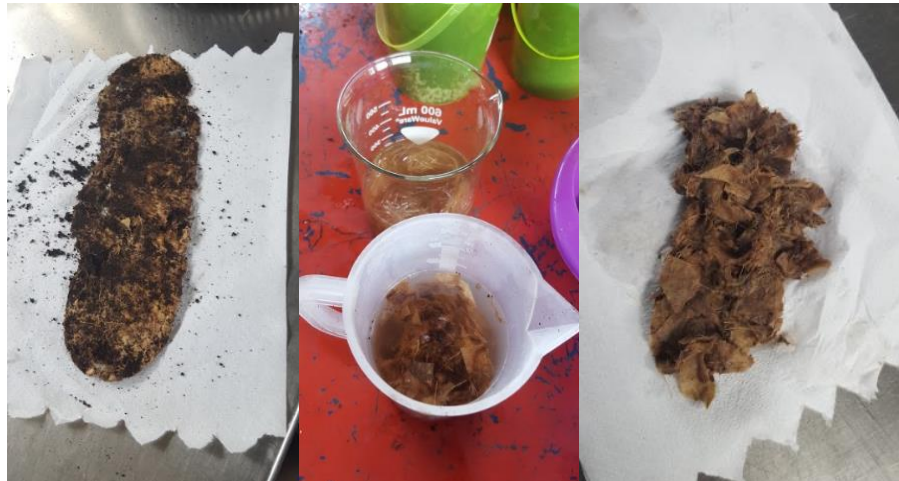
Ilustración 186. Remoción de tierra en las muestras extraídas con una solución de agua y etanol.
