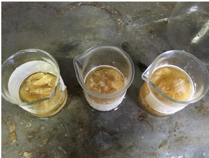
Ilustración 99. Fibras expuestas a KOH al 24 %, etapa 2 proceso de análisis químico
