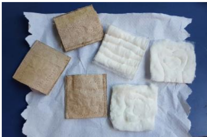
Ilustración 182. Muestras utilizadas para realizar las pruebas de velocidad y factor de capacidad de absorción, toallas sanitarias lote 1 y comerciales.
