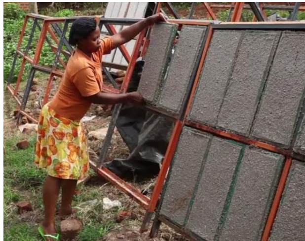
Ilustración 12. Estructura de metal utilizada para el secado y molino de rodillos para la suavización y textura, utilizados en Makapads.
