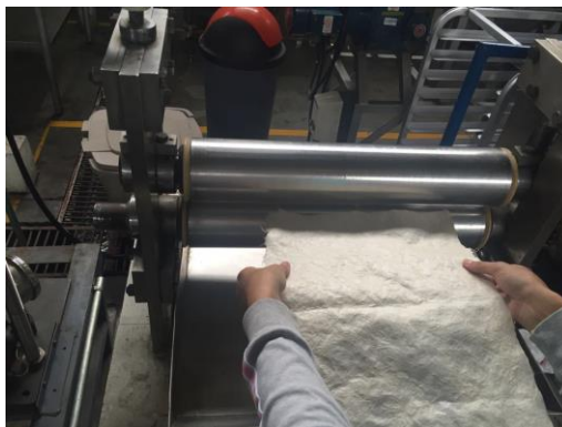
Ilustración No. 33. Pliego de bobina seco en el molino de rodillos del Laboratorio de Operaciones Unitarias de la Universidad del Valle de Guatemala
