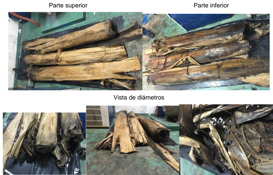
Ilustración 141. Degradación de pseudotallos expuestos al Sol día 101
