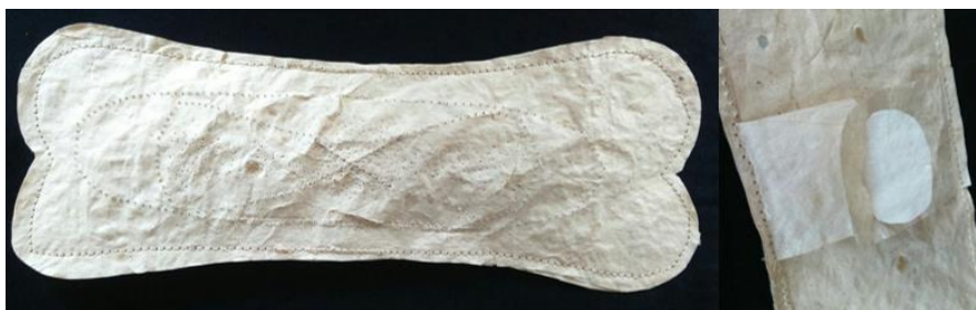
Ilustración 174. Segundo prototipo con alas, costura simple con máquina plana, con perforaciones en la capa superior.
