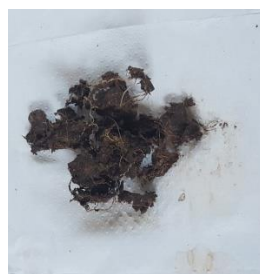
Ilustración 187. Degradación de la toalla sanitaria en un periodo de 80 días de ser enterrada, muestra 1 del primer lote.
