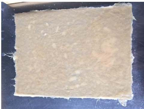
Ilustración 30. Pliego de bobina a base de pasta celulósica
