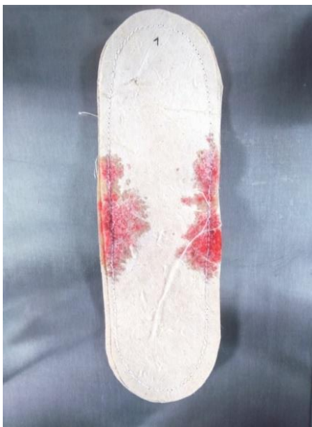
Ilustración 182. Muestras utilizadas para realizar las pruebas de velocidad y factor de capacidad de absorción, toallas sanitarias lote 1 y comerciales.
