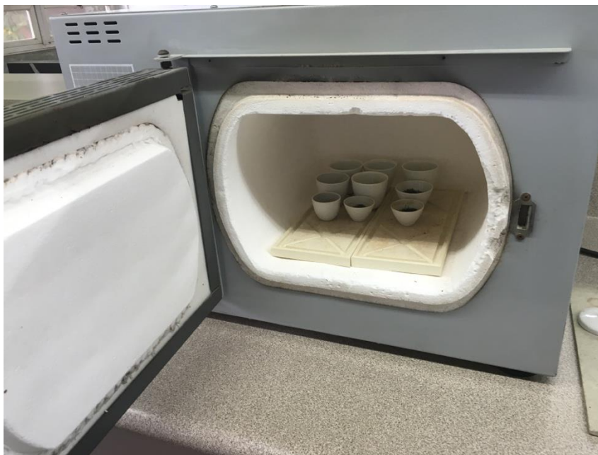
Ilustración 96. Muestras en mufla para ser incineradas a 550 C
