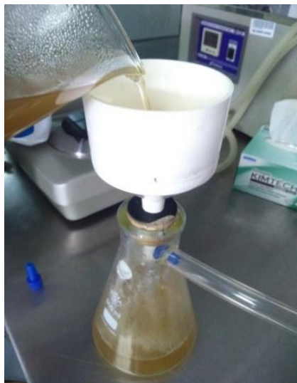
Ilustración 177. Filtrado de solución con goma rabiga, solución Meds.
