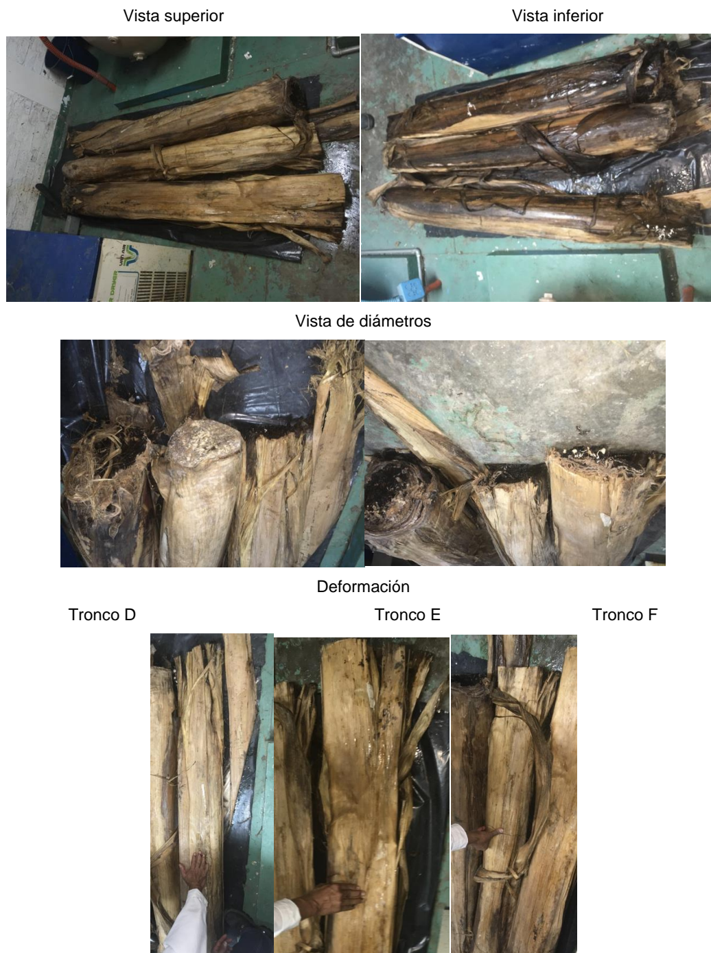
Ilustración 137. Degradación de pseudotallos expuestos al Sol día 80
