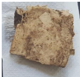
Ilustración 189. Degradación de la toalla sanitaria en un periodo de 80 días de ser enterrada, muestra 3 del primer lote.
