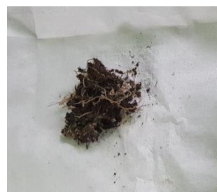
Ilustración 187. Degradación de la toalla sanitaria en un periodo de 80 días de ser enterrada, muestra 1 del primer lote.
