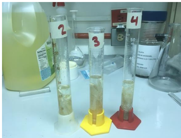
Ilustración 93. Determinación de volumen desplazado por muestras inmersas en aceite para prueba de densidad.
