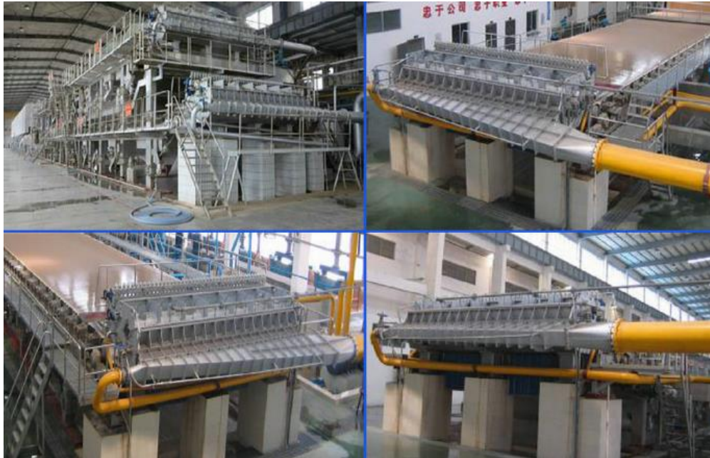
Ilustración 40. Cabeza y caja de entrada de la máquina de papel de mesa plana.
