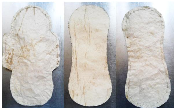
Ilustración 172. Primeros prototipos, cocidos a mano con fibra de pinzote de banano, sin perforaciones
