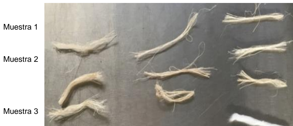
Ilustración 85. Muestras para prueba de retención de agua. Capa foliar central Capa foliar media Capa foliar externa
