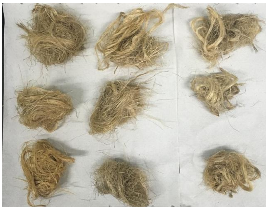
Ilustración 80. Desgaste de la fibra a los 30 días de degradación.
