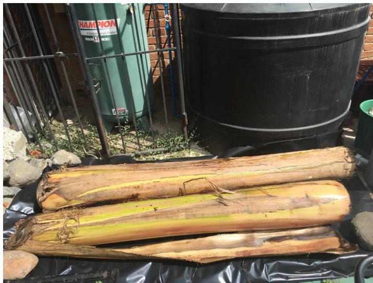
Ilustración 103. Degradación de pseudotallos expuestos al Sol día 1
