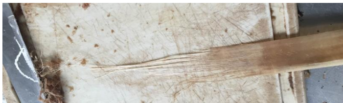
Ilustración 25. Limpieza de la fibra de pinzote de banano.
