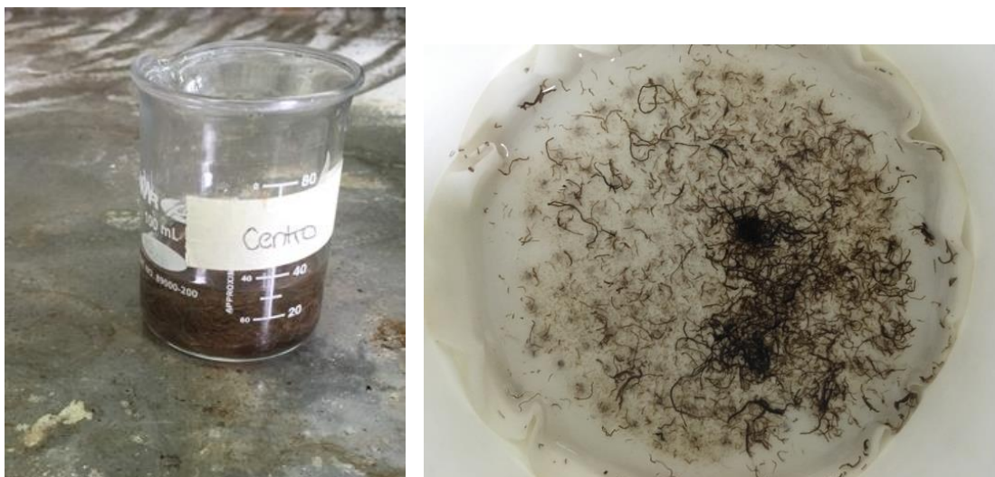
Ilustración 100. Fibra expuesta a H_2SO_4 al 72% y filtración y filtrado, etapa 3 proceso de análisis químico
