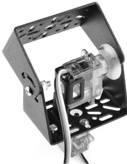
Figura 156. Soporte de inclinación y paneo seleccionado para el acople de servomotores y componentes electrónicos.
