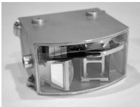
Figura 60. Sensor de escaneo láser de AUDI.
