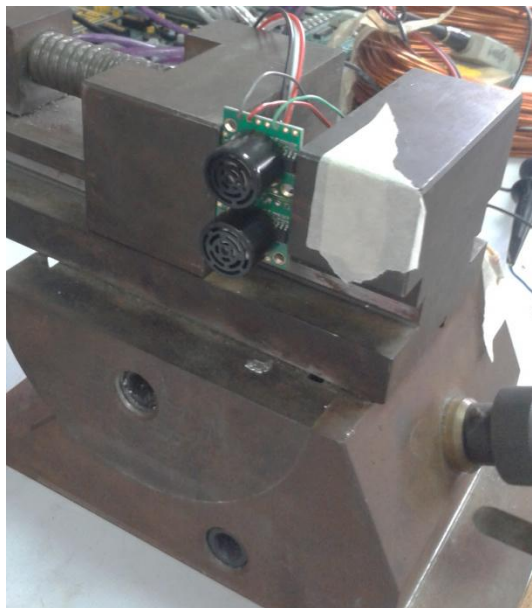
Figura 26. Sensores ultrasónicos en prueba de funcionamiento simultáneo.
