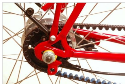
Ilustración 33 Ejemplo de utilización de faja en lugar de la tradicional cadena de transmisión
