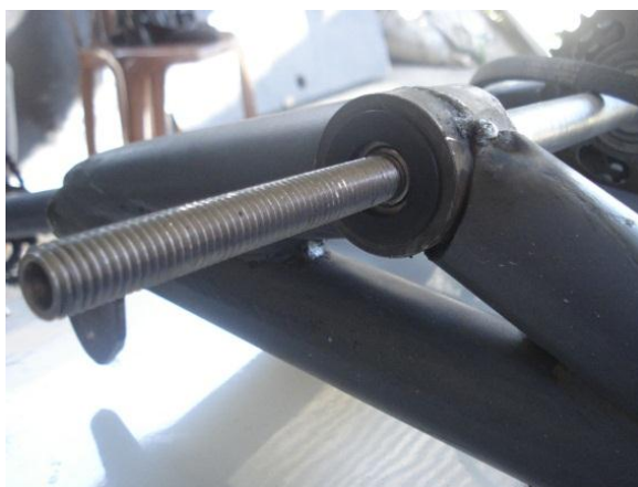
Ilustración 73 Ensamble del manguito o bufa con el rodamiento y el eje.
