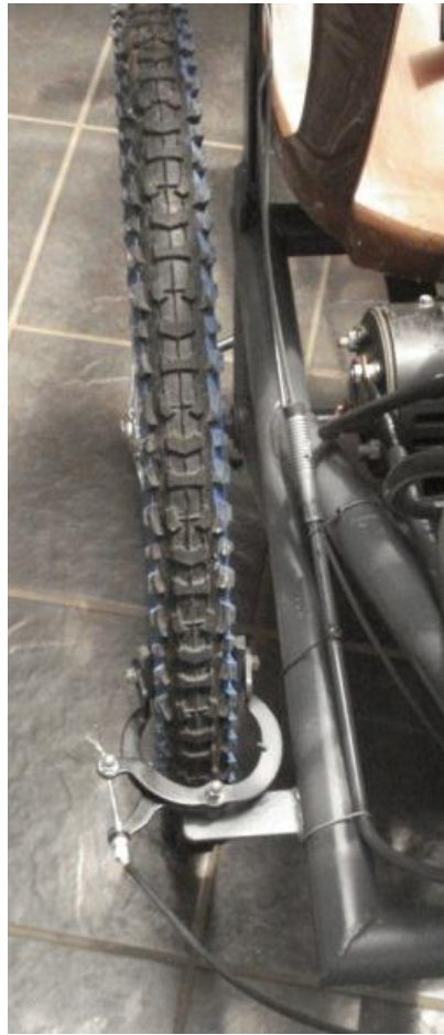
Ilustración 71 Frenos instalados en el chasis del prototipo.
