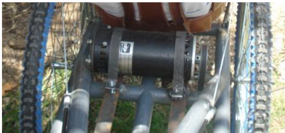
Ilustración 69 Motor fijado al chasis por las abrazaderas diseñadas.
