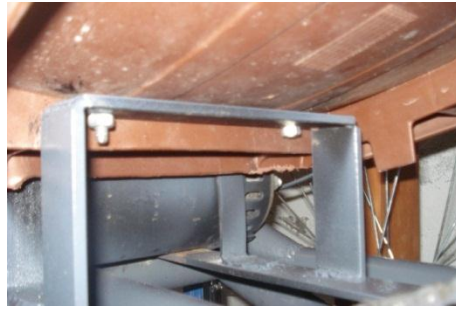
Ilustración 67 Fotografía de la base construida para la colocación del asiento.
