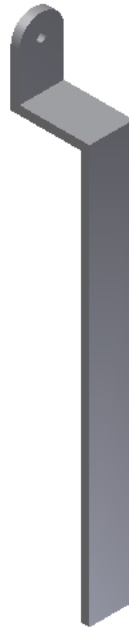
Ilustración 62 Representación gráfica de la base para las palancas de dirección
