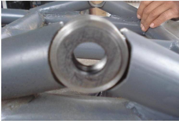
Ilustración 74 Vista general del manguito o bufa previo a su instalación en la estructura del chasis.
