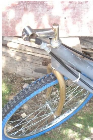
Ilustración 61 Cables conectados en la prolongación del timón para la dirección del vehículo.
