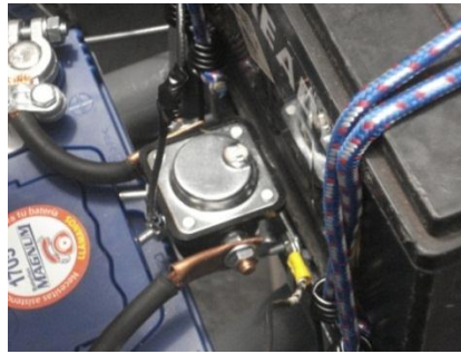
Ilustración 60 Fotografía del solenoide que realiza la función de contactor para controlar el circuito.
