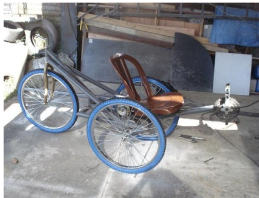
Ilustración 68 Asiento instalado en la estructura del triciclo.
