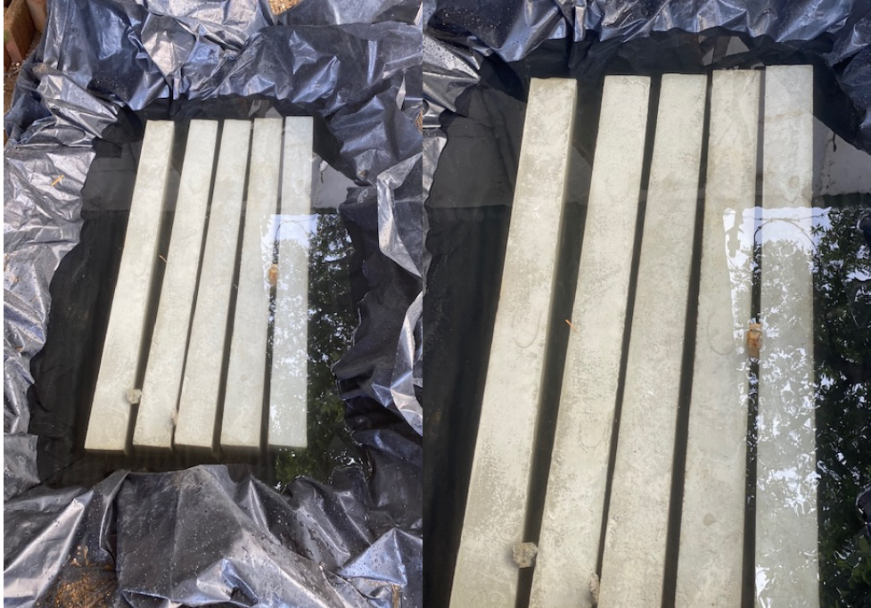
Figura 22: Curado de vigas (Fuente: Elaboración propia)
