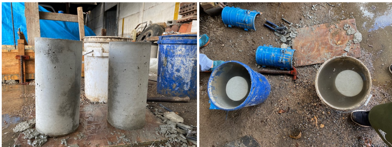
Figura 31: Desencofrado y curado de cilindros (Fuente: Elaboración propia)
