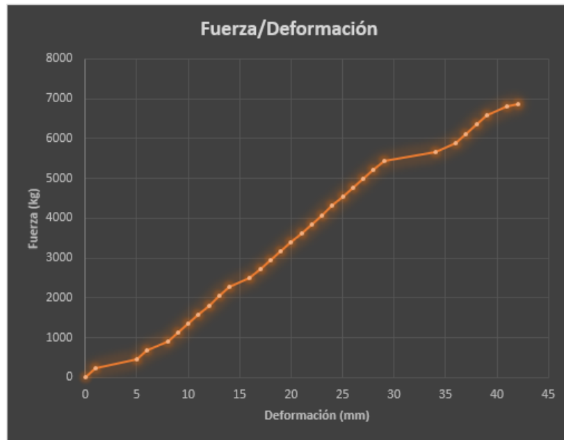
Figura 47: Gráfica fuerza/deformación de segunda viga con dos capas de malla (Fuente: Elaboración propia)
