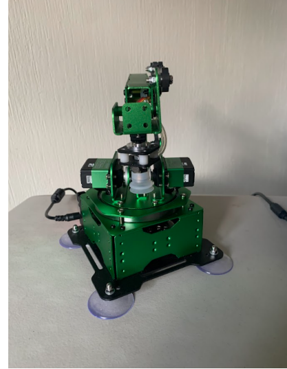
Figura 11: Prueba de posición con q = [28.3, 53.9, 56.0, 2.1, 120.0] en las juntas
