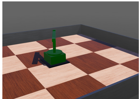
Figura 21: Prueba de posición con q = [28.3 \ 53.9 \ 56.0 \ 2.1 \ 120.0] en las juntas
