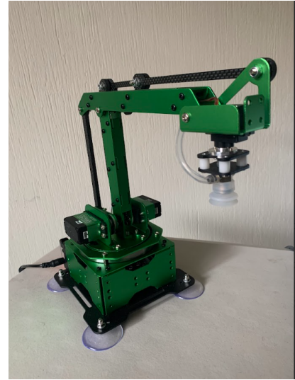
Figura 9: Prueba de posición con q = [0, 0, 0, 0, 0] en las juntas
