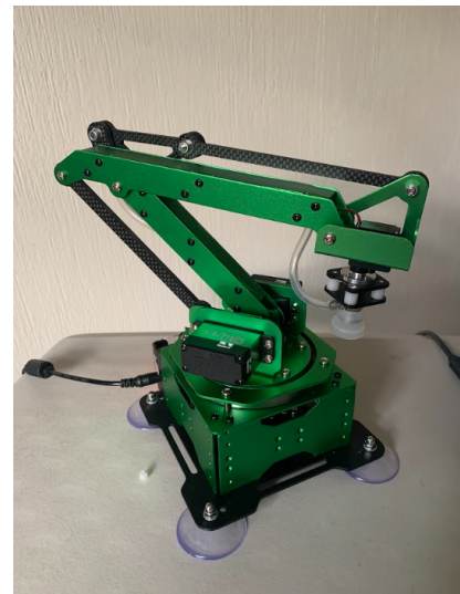
Figura 10: Prueba de posición con q = [-60.2, 46.9, 54.0, 7.1, 45.0] en las juntas
