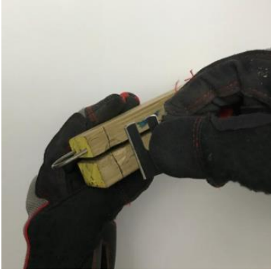
Colocar cuchilla que corta fibras
