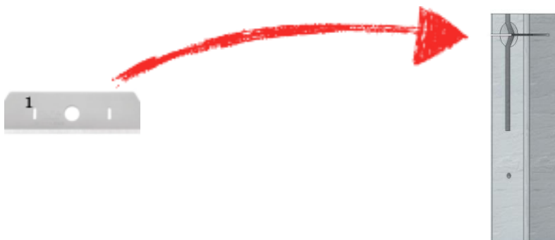
Ilustración 4: Colocación de la cuchilla que corta las fibras de la botella
