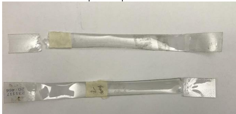
Ilustración 34: Falla de las primeras pruebas sin material intermedio
