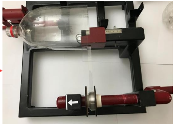
Verificar que la botella se mantenga alineada a la pieza metálica que varía los anchos.
