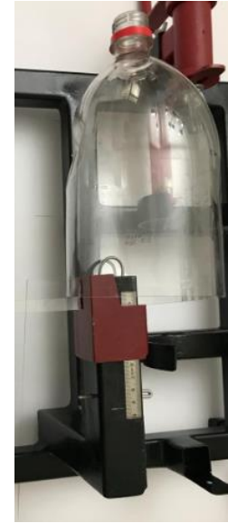
Girar la botella hasta obtener las primeras fibras
