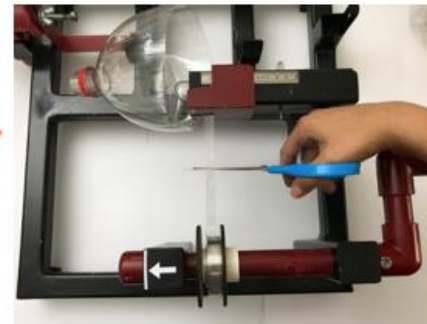
Cortar antes de que empiece la superficie irregular de la botella
