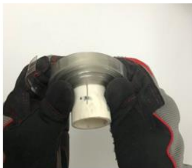
Retirar el PVC de las fibras
