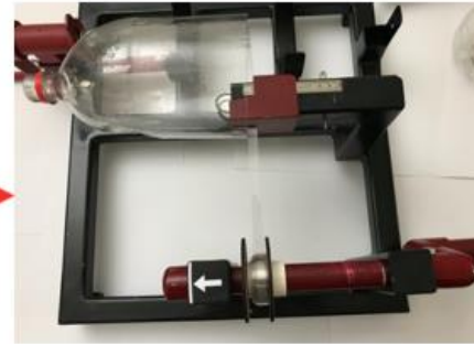
Verificar que la botella se mantenga alineada a la pieza metálica que varía los anchos.
