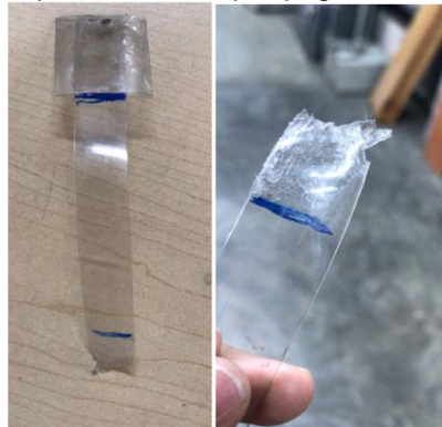
Ilustración 33: Ruptura de fibras por pegamento de contacto.
