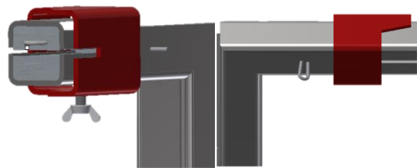
Ilustración 25: Mecanismo para variar el ancho de las fibras ensamblado en el mecanismo en dos vistas
