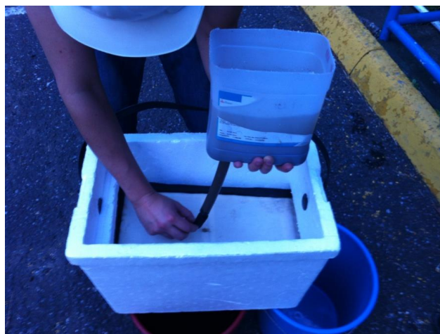
Figura No. 49. Sistema de filtración para eliminar el exceso de agua en los sólidos residuales.
