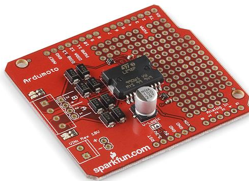
Ilustración 31: Placa de controlador Ardumotor [2]
