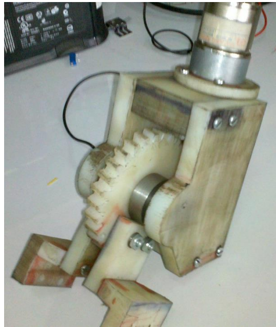
Ilustración 43: Vista general de la caja reductora
