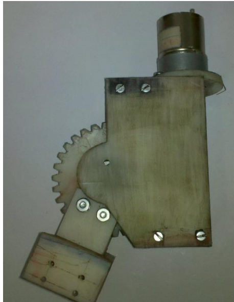
Ilustración 41: Vista frontal de la caja reductora
