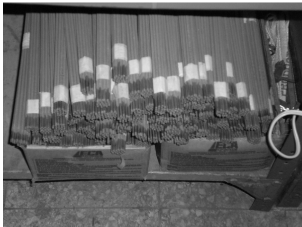
Ilustración No. 13 Electrodo con colillas pintadas después de la implementación de las 5-S
