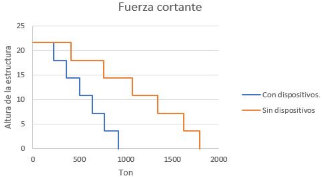
Figura 70: Fuerza cortante de la estructura. [Elaboración propia.]
