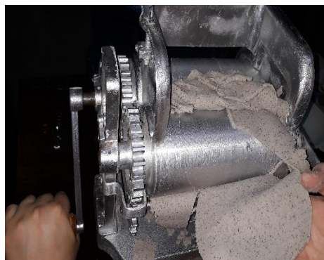
Figura 40. Formación de tortillas con máquina tortillera Gonzalez
