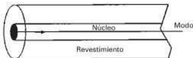
Figura 16: Fibra óptica monomodo (núcleo entre 5 y 10 \mu\text{m} , revestimiento de 125 \mu\text{m} ).
