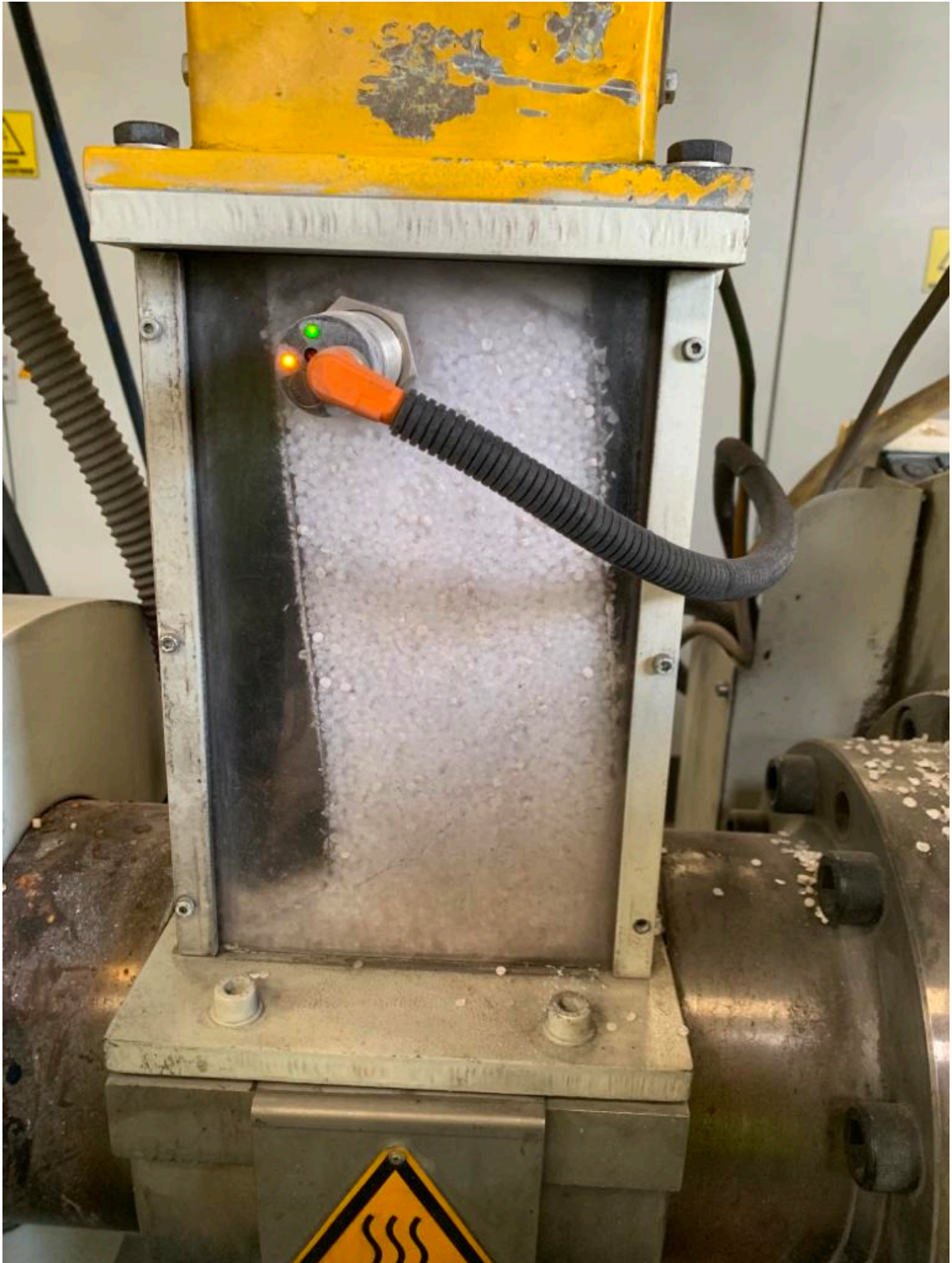
Figura 23. Tolva de llenado de polipropileno en extrusor Starex 8.
