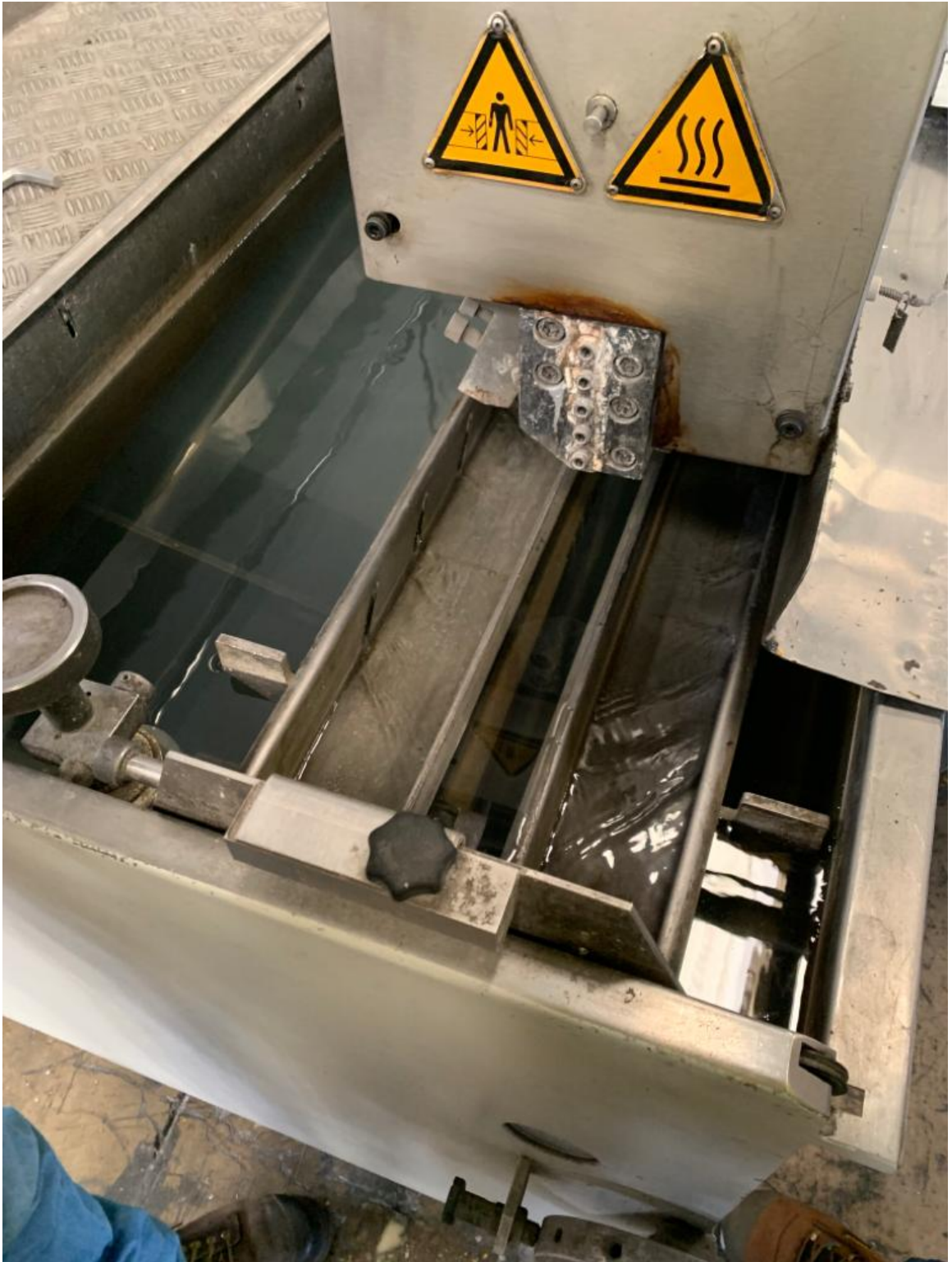
Figura 15. Extrusión de película de PP a tanque de enfriado.
