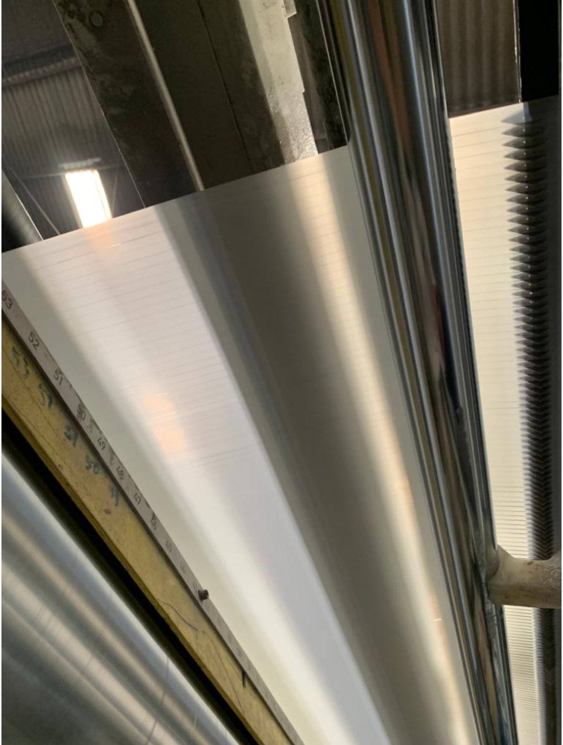
Figura 17. Corte de PP a rafia con cuchillas.
