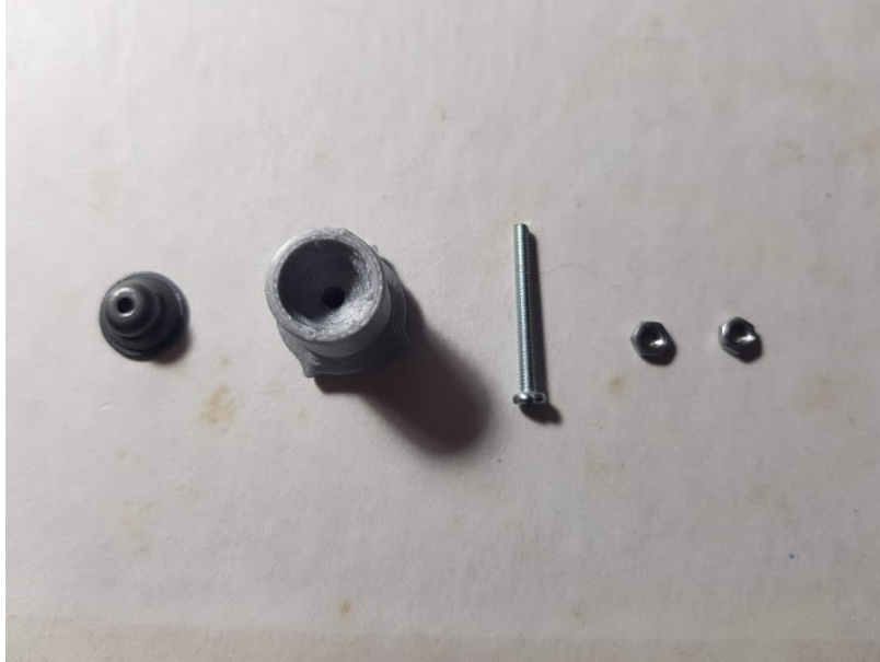
Figura 24: Partes de cada uno de los nodos de electrodos: electrodo, parte impresa, tornillo y tuercas.
