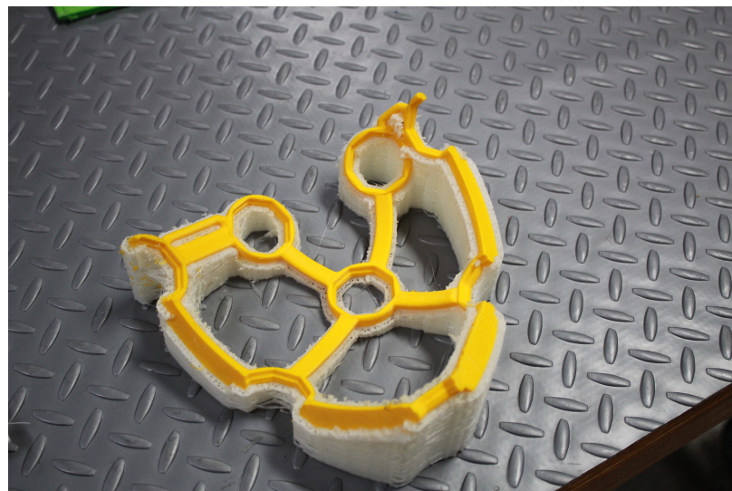
Figura 23: Parte del casco impresa en la impresora Ultimaker de la UVG cuando todavía tiene adherido el material de soporte.
