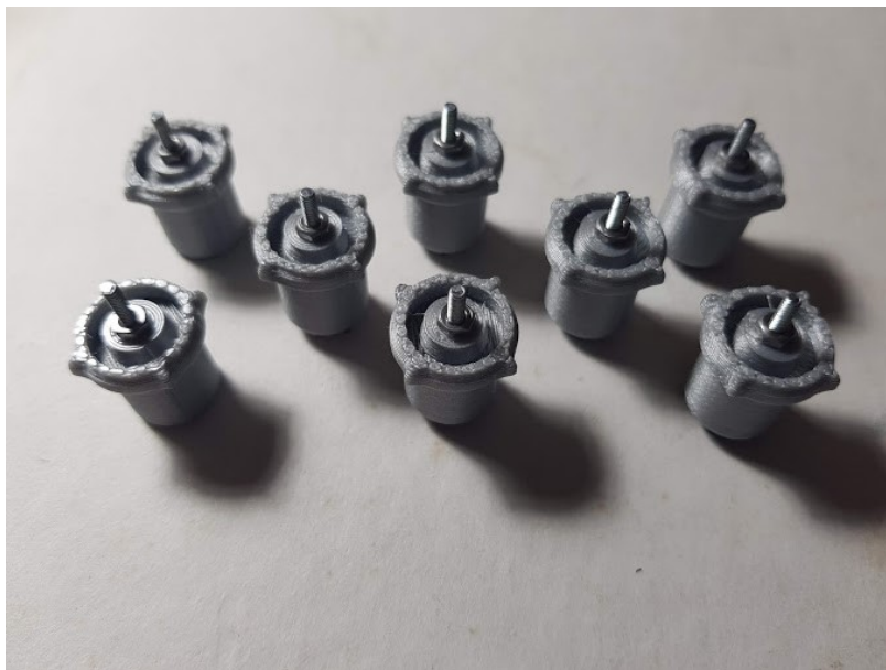
Figura 25: Nodos de electrodos con sus partes ya ensambladas.
