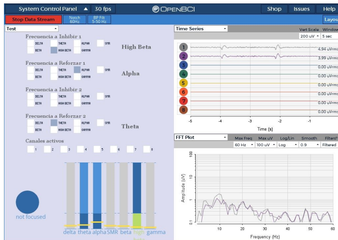
Figura 36: Programa basado en la interfaz gráfica de OpenBCI en el que se pueden elegir dos ondas para inhibir y dos ondas para reforzar y los canales activos que se tomarán en cuenta. Situación en la que el usuario no está concentrado. No se cumple con las condiciones del umbral de recompensa en Theta y Alpha y solamente se cumple con la condición del umbral de inhibición en High Beta.
