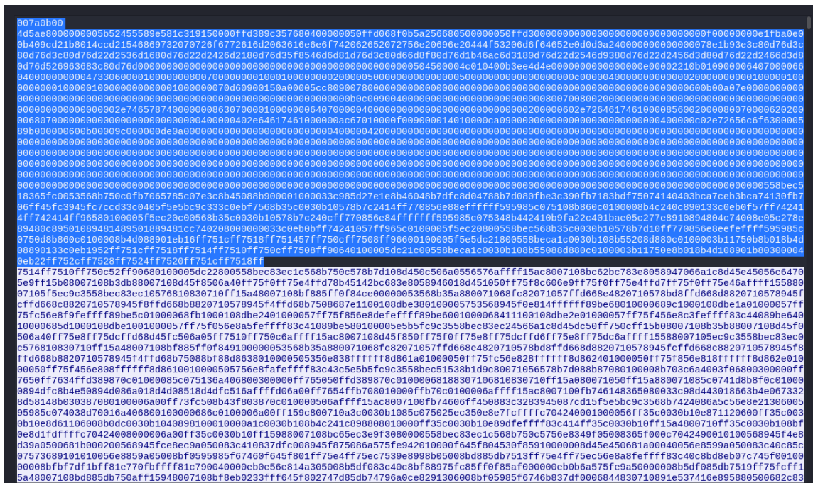
Figura 6.14: Stream TCP malicioso en el puerto 4444 raw
