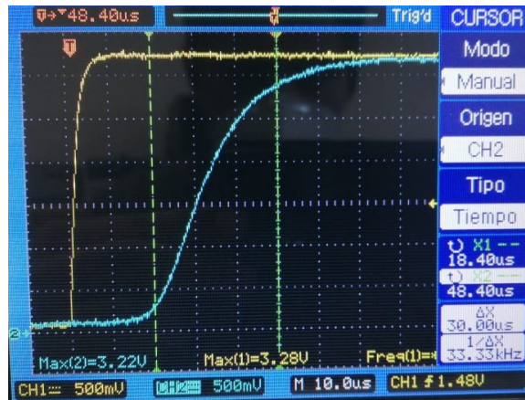
Figura 66: Salida del convertidor XTR111 con resistencia de carga de 1K \Omega .
