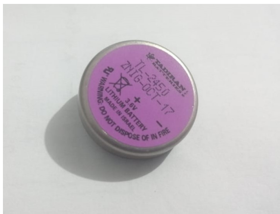
Figura 61: Batería de litio de forma circular de 550 mAh.
