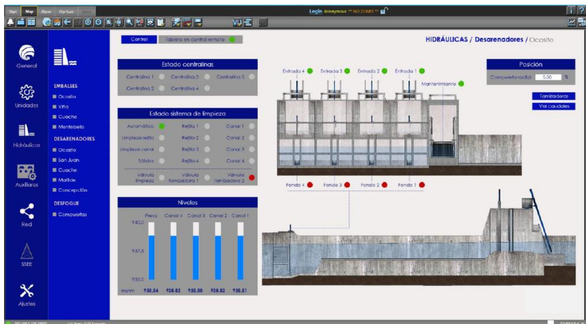
Figura 43. Interfaz de control y monitoreo, pantalla principal de desarenador.
