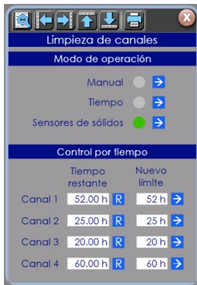
Figura 46. Interfaz de control y monitoreo, control panel para modo de control de limpieza de canal.
