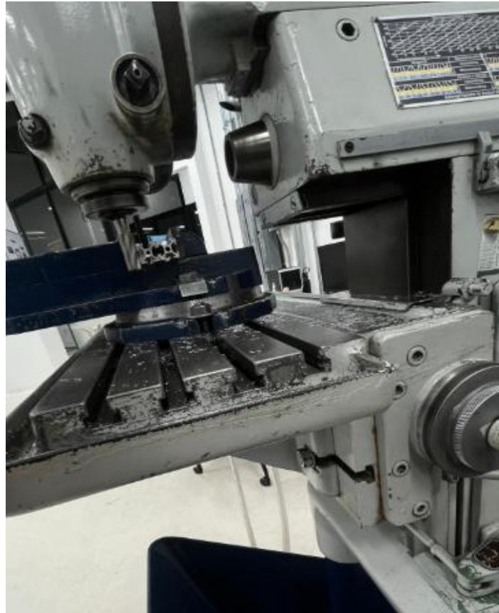
Figura 1. Corte y rectificación de perfiles extruidos de 20x20 mm
