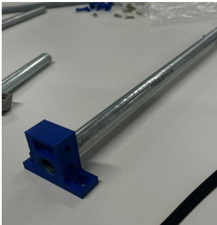
Figura 5. Ensamble parcial del eje x con guías lineales y transmisión
