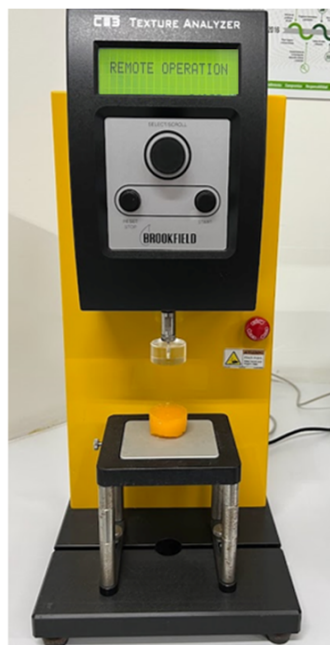
Figura 10: Phantom colocado en la base del analizador de texturas CT3 perfectamente alineado al cabezal.
