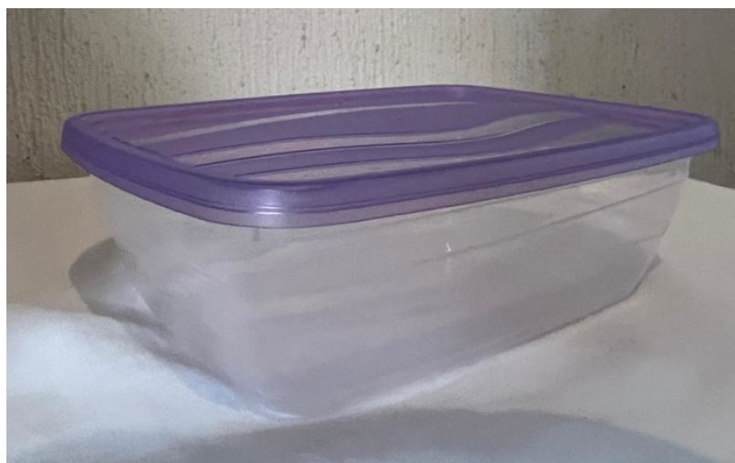
Figura 59: Molde utilizado para el desarrollo de phantoms para pruebas con ultrasonido.
