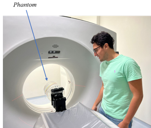
Figura 7: Phantom utilizado para probar, certificar, optimizar y calibrar un equipo de tomografía computarizada.
