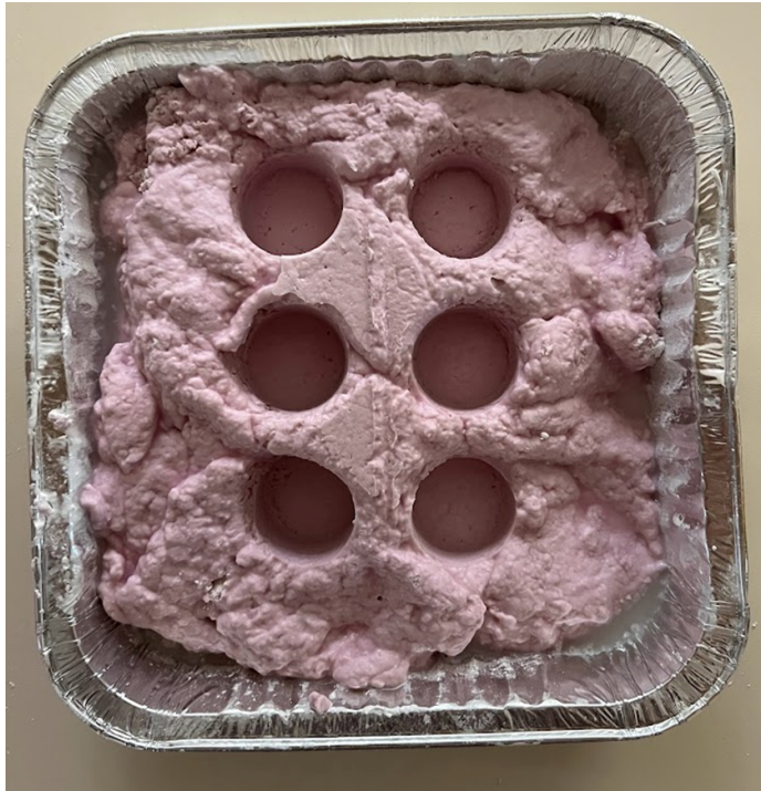
(a) Mezcla del alginato solidificada. (b) Creación de pequeños phantoms en el molde de alginato.
