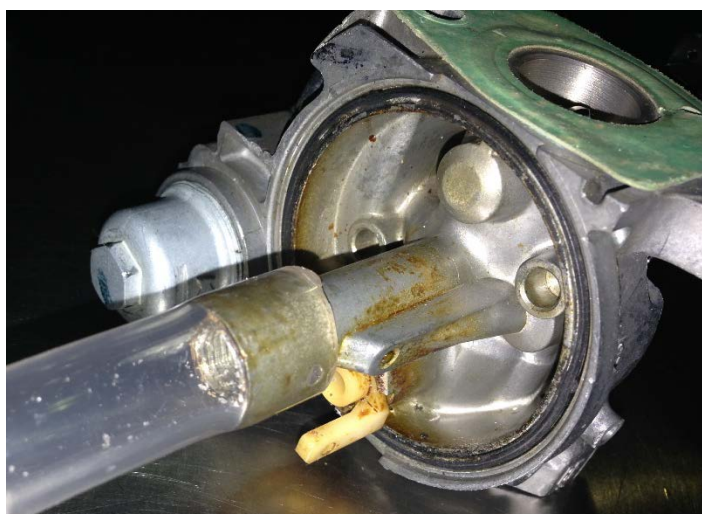
Figura 25. Vista lateral de la línea de ingreso de mezcla combustible al carburador
