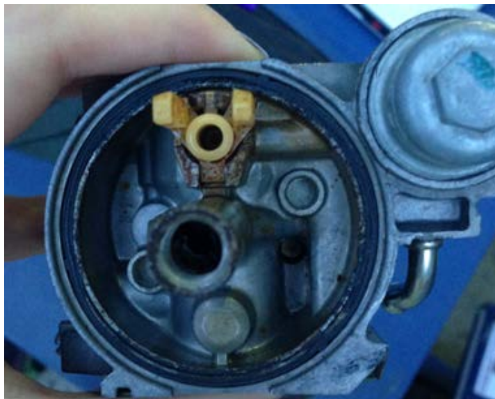
Figura 23. Parte del carburador del motor Honda GX-120 utilizada para la combustión con hidrógeno
