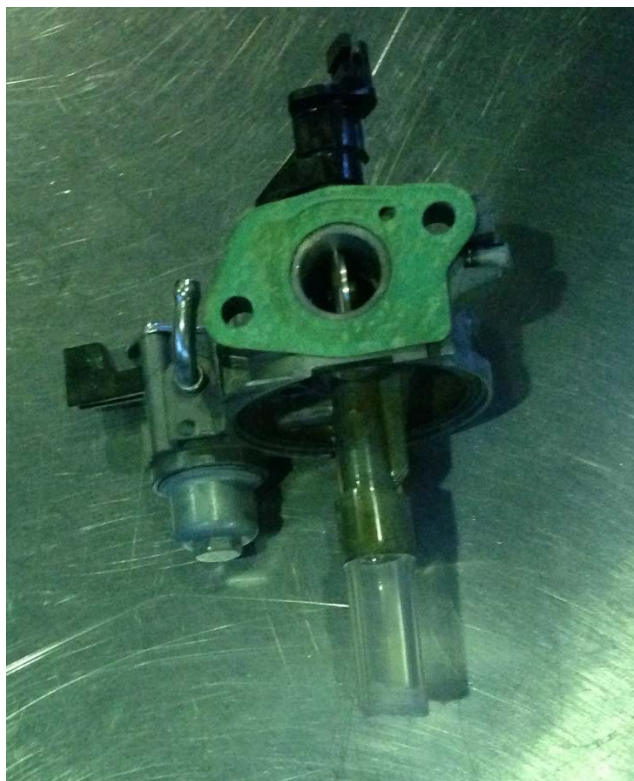
Figura 24. Vista en elevación de la línea de ingreso de mezcla combustible al carburador
