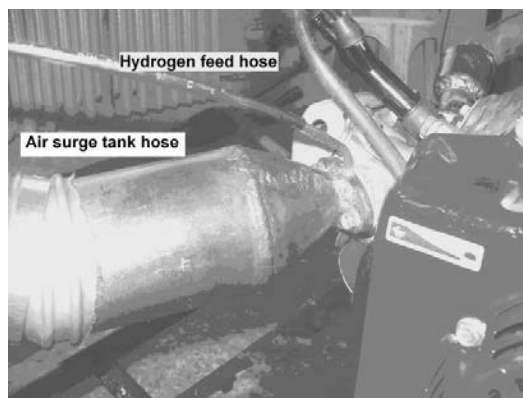
Figura 14. Modificación para ingreso de hidrógeno al motor
