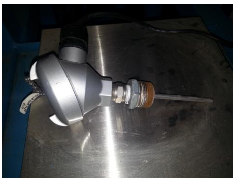
Figura 13. RTD utilizada en el proyecto
