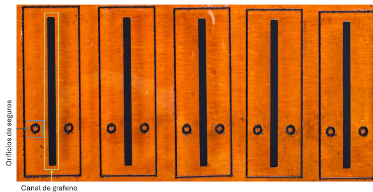
Figura 16. Electrodo fabricados sobre Kapton® de 75 \mu\text{m} de espesor mediante grabado láser con parámetros de potencia del 17% y velocidad del 7.5% para inducción al grafeno
