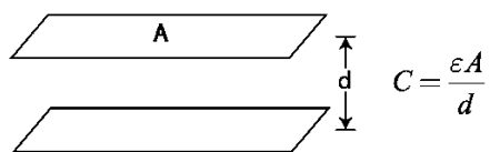
Figura 3. Ecuación para un capacitor de placas paralelas.
