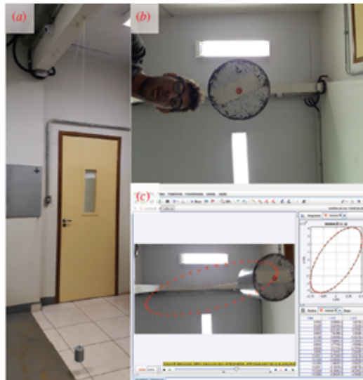
Figura 4.6: Sistema del péndulo esférico como una analogía a la segunda ley de Kepler Nota. Tomado de “Spherical Pendulum as analogy to Kepler’s second law”, por Canassa et al., 2019, Physics Education.
